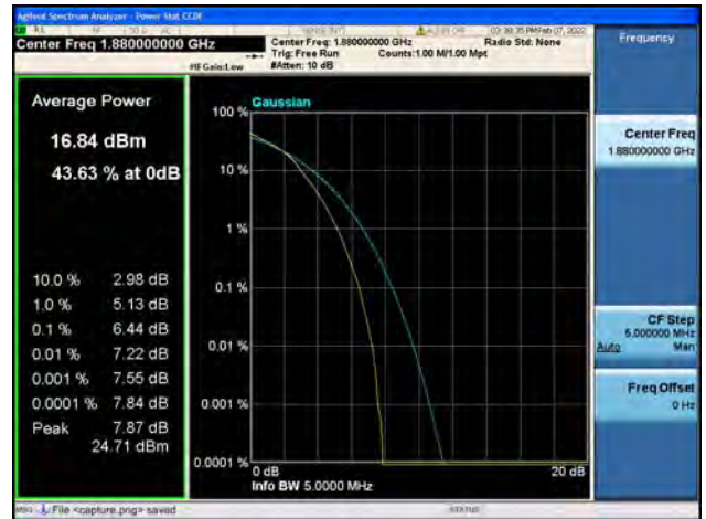
Band2 / 5MHz / High CH / 16QAM
