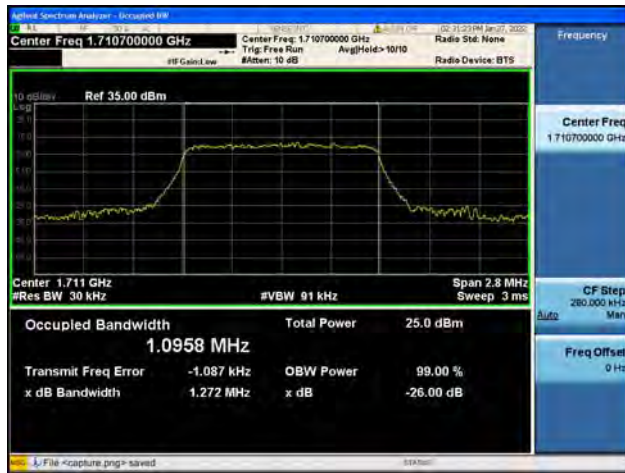
Band66 / 1.4MHz / Mid CH / QPSK
