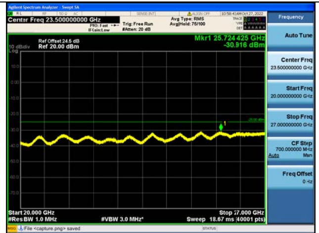
Band41C-20G-27G / 20MHz+20MHz /1RB+1RB/ QPSK / Mid CH
