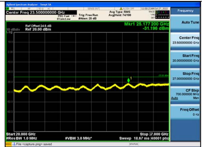
Band41C-20G-27G / 5MHz+20MHz / 1RB+1RB / QPSK / High CH
