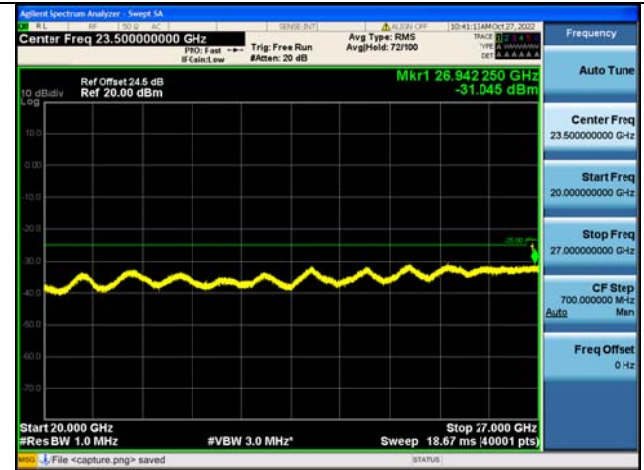
Band41C-20G-27G / 20MHz+5MHz / 100RB+25RB / QPSK / Mid CH
