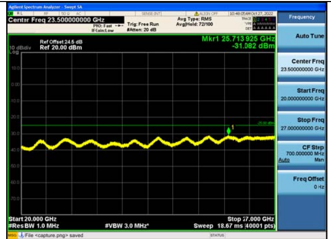
Band41C-20G-27G / 15MHz+10MHz /75RB+50RB/ QPSK / Mid CH
