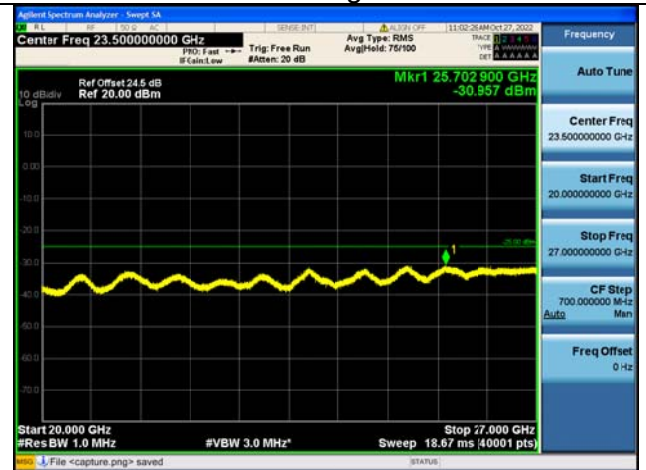
Band41C-20G-27G / 20MHz+5MHz / 1RB+1RB / QPSK / High CH
