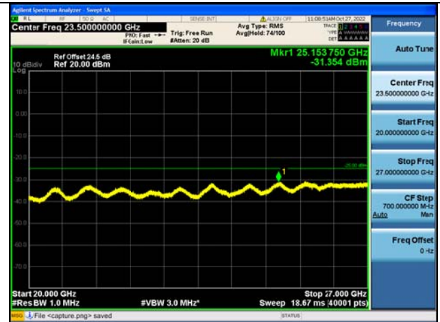
Band41C-20G-27G / 20MHz+10MHz /1RB+1RB/ QPSK / High CH
