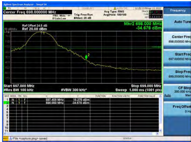
Band71 / 10MHz / High CH / QPSK / 1 RB
