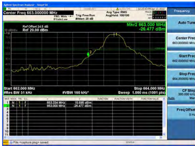
Band71 / 5MHz / High CH / QPSK / 1 RB
