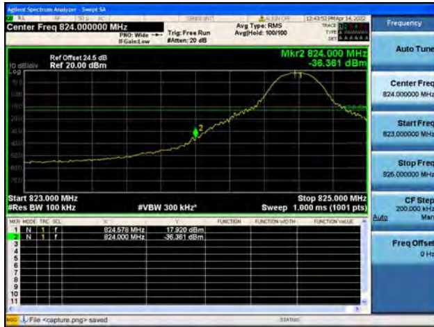
Band26 / 10MHz / High CH / QPSK / 1 RB
