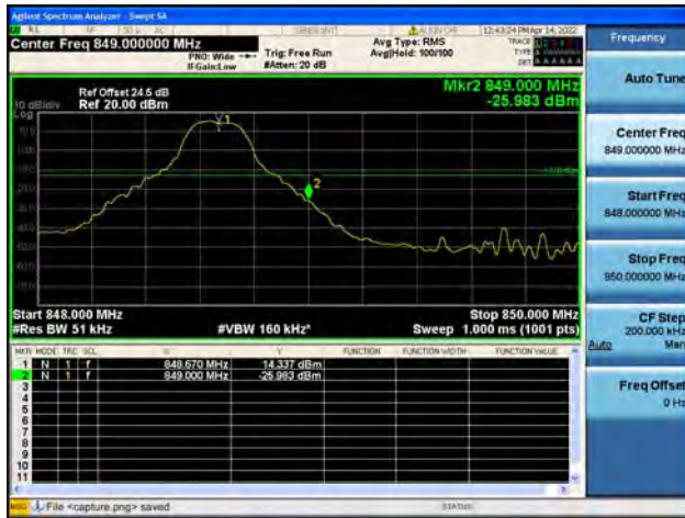
Band26 / 5MHz / High CH / QPSK / 1 RB
