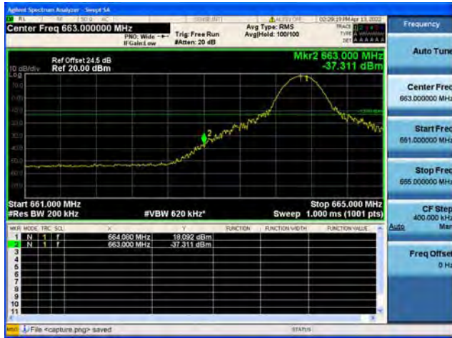
Band71 / 20MHz / High CH / QPSK / 1 RB
