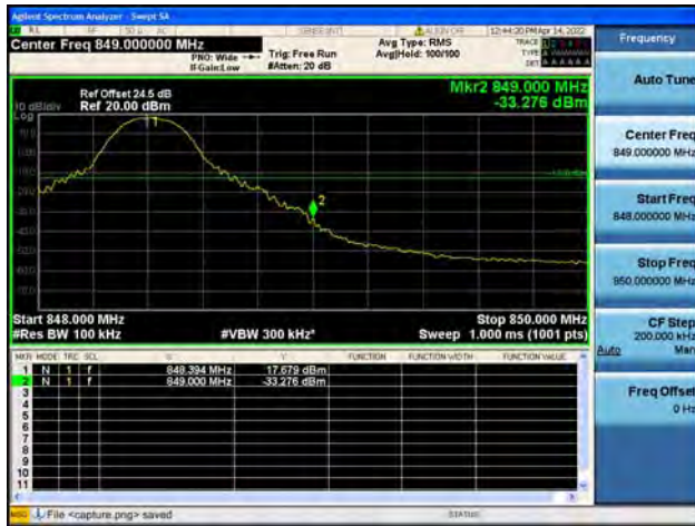
Band26 / 10MHz / High CH / QPSK / 1 RB
