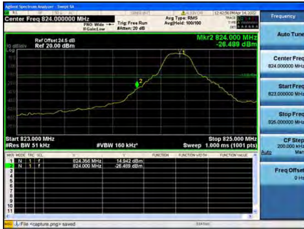
Band26 / 5MHz / High CH / QPSK / 1 RB
