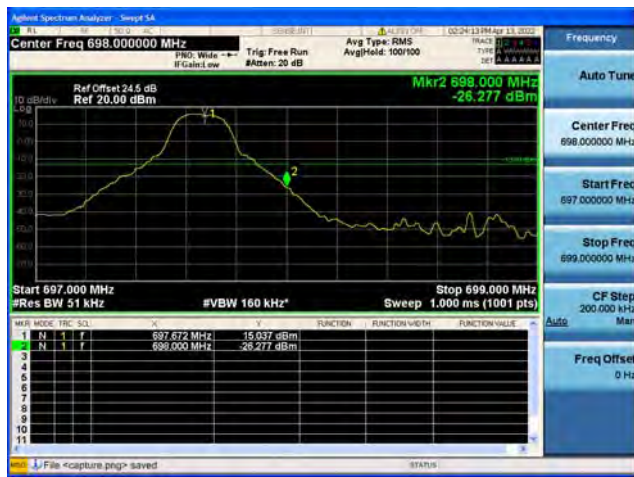
Band71 / 5MHz / High CH / QPSK / 1 RB
