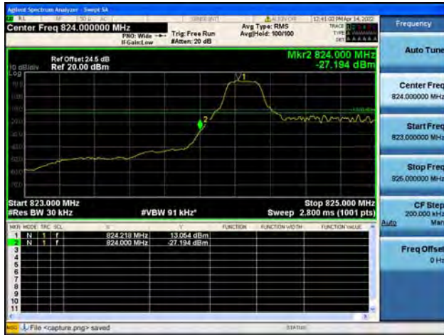
Band26 / 1.4MHz / High CH / QPSK / 1 RB
