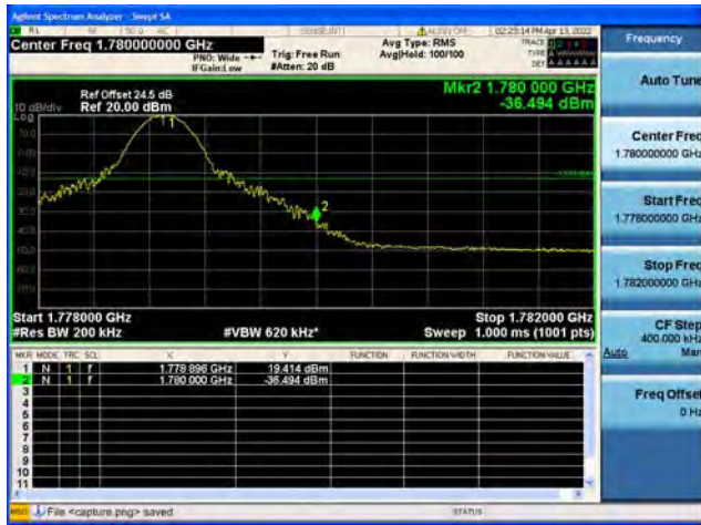
Band66 / 20MHz / High CH / QPSK / 1 RB
