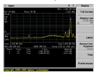
$\pi$  /4-DQPSK: Band Edge-Low Channel (Hopping Mode)
