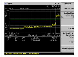
$\pi$  /4-DQPSK: Band Edge-High Channel
