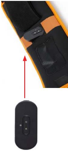
2. Pressez l'autre côté du module intelligent dans la fente fixe.
