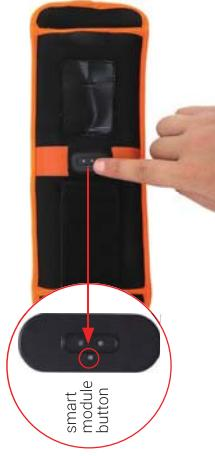
2.1.3-2 Si le voyant bleu ne s'allume pas et que l'appareil ne vibre pas lorsque vous appuyez sur le bouton, veuillez charger complètement le module intelligent avec le câble de chargement fourni et appuyez légèrement sur le bouton du module intelligent pour entrer dans l'état de couplage. Le témoin lumineux rouge reste allumé en permanence et passe à une couleur verte fixe lorsque le module intelligent est entièrement chargé.
