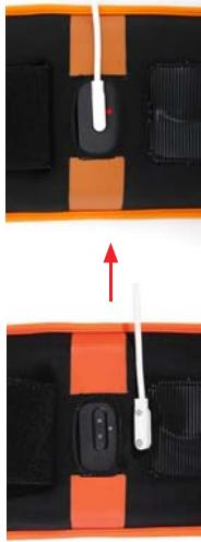
2. L'indicateur s'allume en rouge pendant le chargement et passe au vert lorsque l'appareil est complètement chargé.
