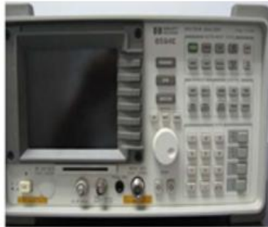
HP 8594E 频谱分析仪 Spectrum Analyzer
