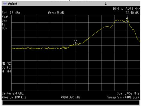
Band Edge 2483.5 MHz Tuned Freq = 2480 MHz
