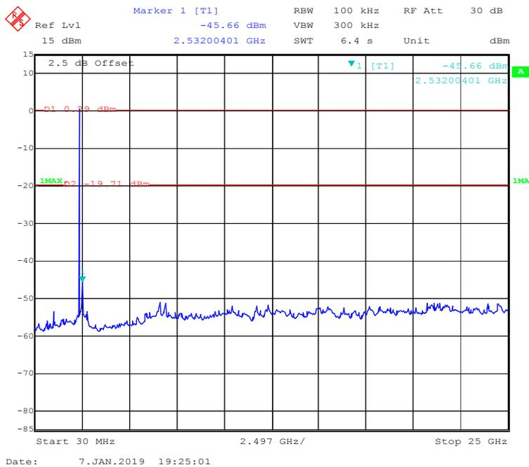
**EDR ( $\pi/4$ -DQPSK): Middle Channel**
