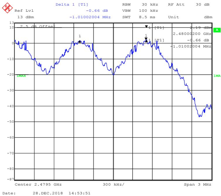
**EDR ( $\pi/4$ -DQPSK): Low Channel**
