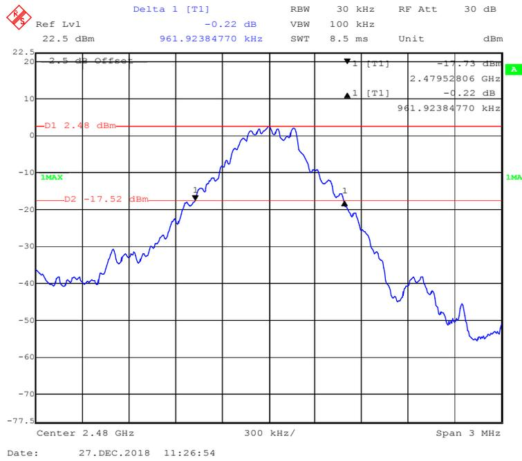
**EDR ( $\pi/4$ -DQPSK): Low Channel**
