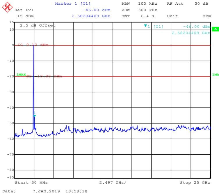
**EDR ( $\pi/4$ -DQPSK): High Channel**
