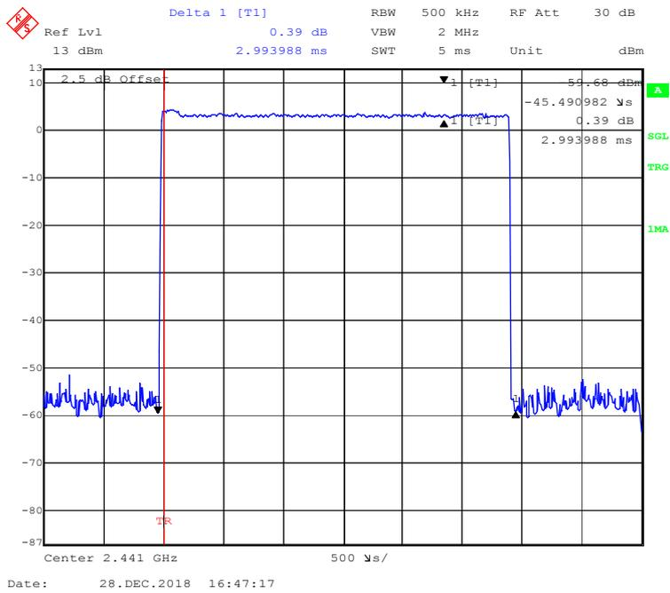
**EDR ( $\pi/4$ -DQPSK):Pulse time, High Channel, 2DH5**
