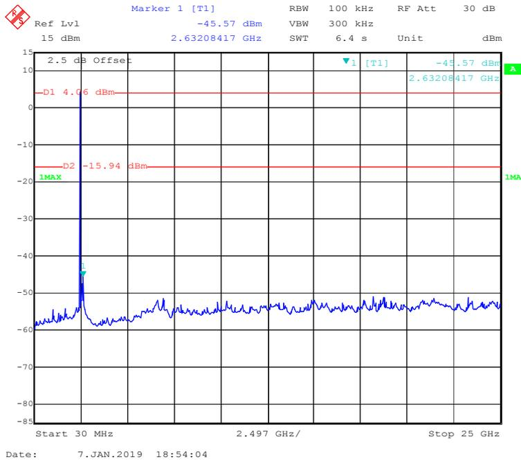
**EDR ( $\pi/4$ -DQPSK): Low Channel**
