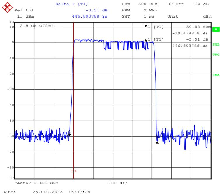
**EDR ( $\pi/4$ -DQPSK):Pulse time, Middle Channel, 2DH1**
