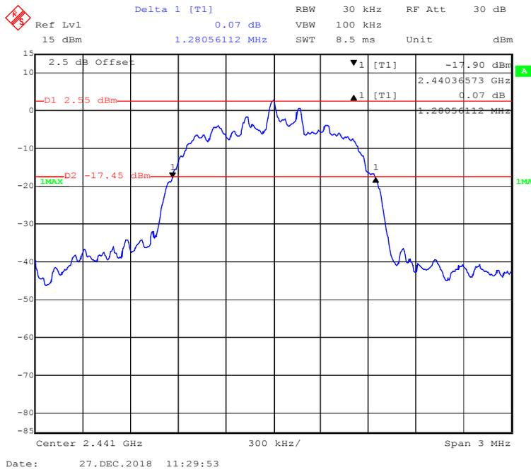
**EDR ( $\pi/4$ -DQPSK): High Channel**
