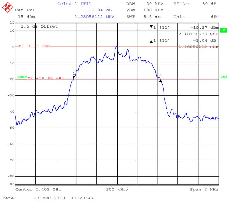
**EDR( $\pi/4$ -DQPSK): Middle Channel**
