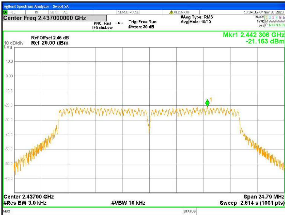
PSD NVNT g 2437MHz Ant1
