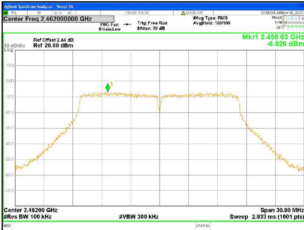
Band Edge NVNT g 2462MHz Ant1 Ref
