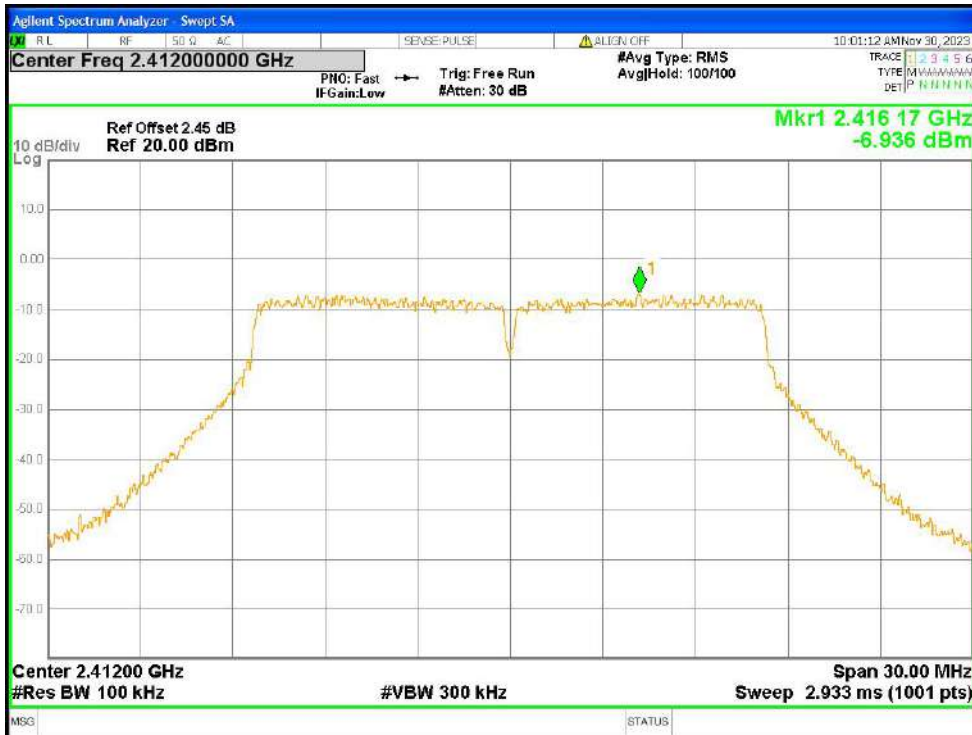
Band Edge NVNT g 2412MHz Ant1 Ref
