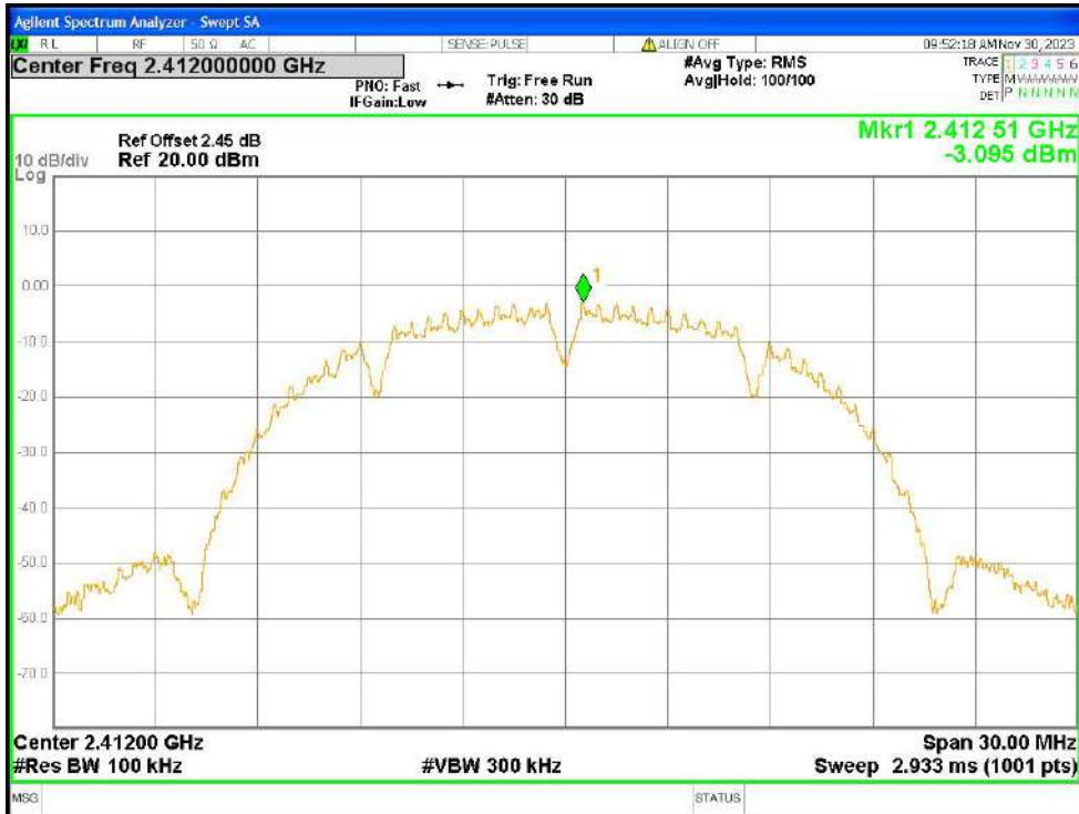
Band Edge NVNT b 2412MHz Ant1 Ref
