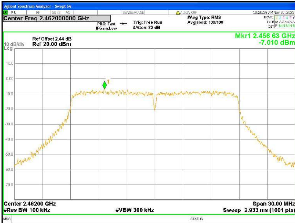
Band Edge NVNT n20 2462MHz Ant1 Ref
