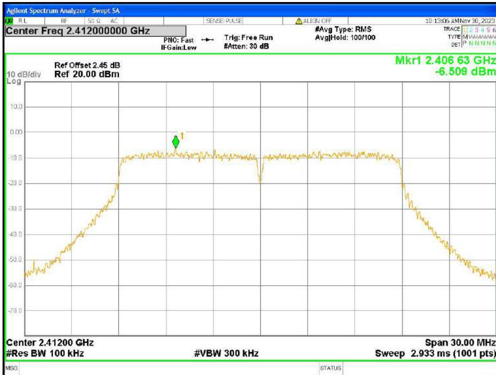
Band Edge NVNT n20 2412MHz Ant1 Ref
