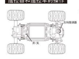
操作提示: · 请确保电源开关是处在 "ON" 的位置上 当您在操作时,如电源开关是处在"OFF" 时, 遥控车是无功能的。 • 当遥控车在直线行驶时向左偏移, 请将 此方向微调器向右微调,直到遥控车恢复正确 的行驶路线。 • 当遥控车在直线行驶时向右偏移,请将 此方向微调器向左微调,直到遥控车恢复正确 的行驶路线。
