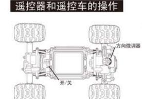
操作提示: · 请确保电源开关是处在 "ON" 的位置上 当您在操作时,如电源开关是处在"OFF" 时,遥控车是无功能的。 · 当遥控车在直线行驶时向左偏移, 请将 此方向微调器向右微调,直到遥控车恢复正确 的行驶路线。 当遥控车在直线行驶时向右偏移,请将 此方向微调器向左微调,直到遥控车恢复正确 的行驶路线。
