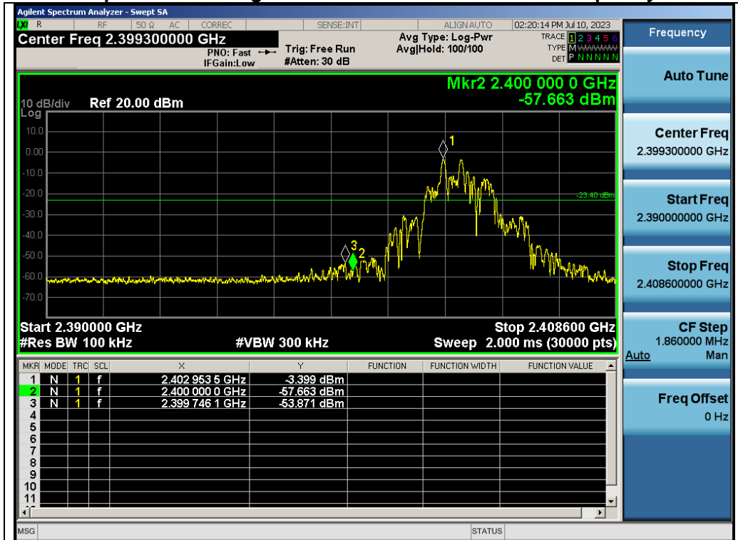
Test_Graph_ANT1_2403.6_Lower Band Edge Emissions
