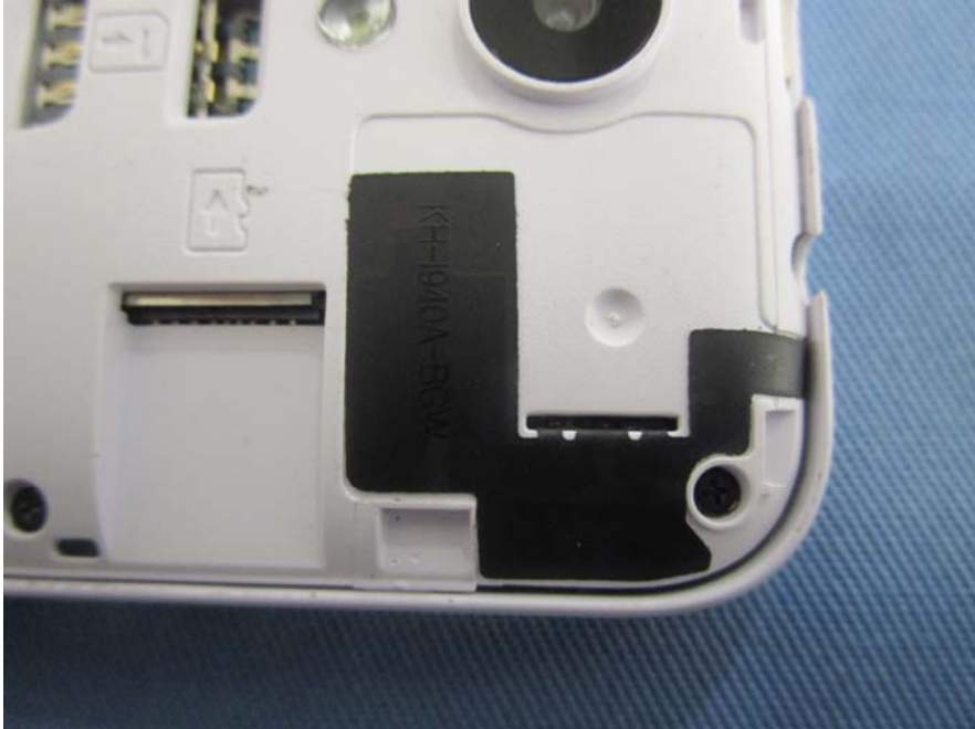
EUT –BT&WIFI&GPS Antenna View
