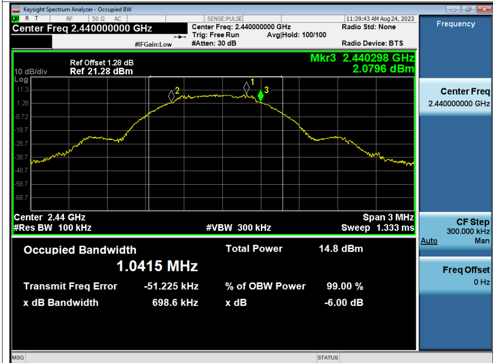
-6dB Bandwidth NVNT BLE 1M 2440MHz Ant1
