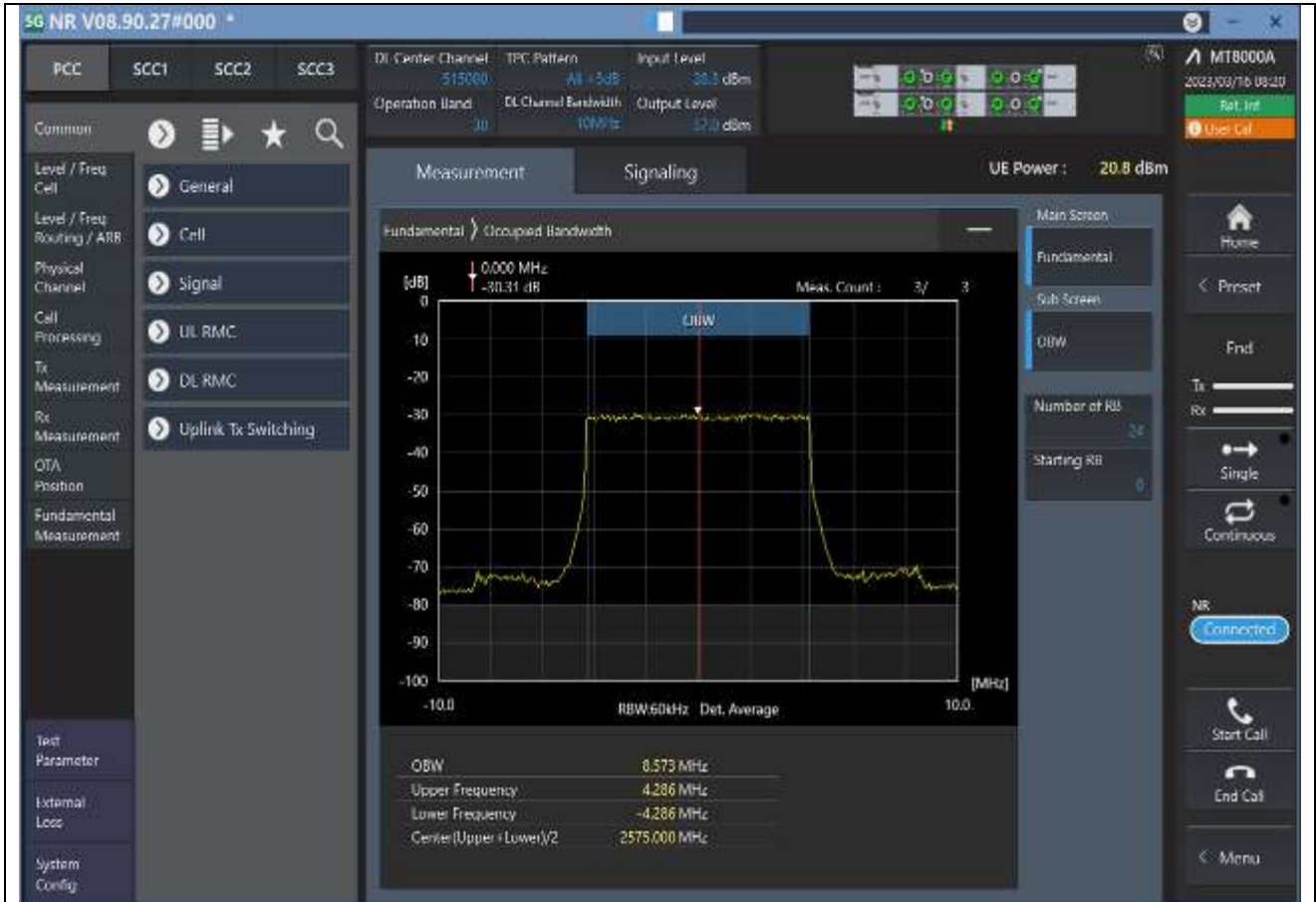
n38_10MHz_30kHz_515000_DFT-s-OFDM PI/2 BPSK^Outer_Full
