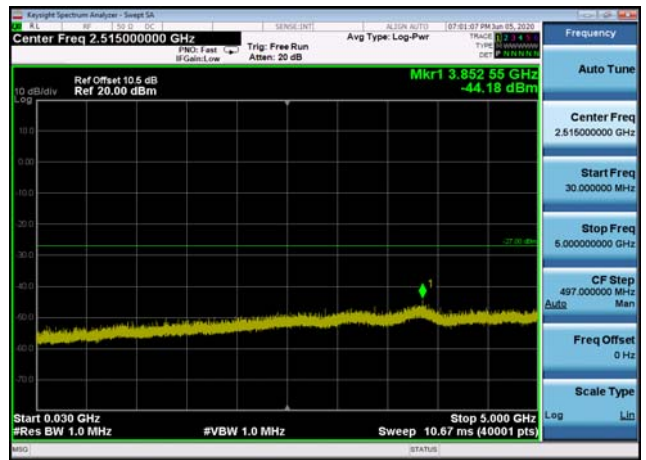
U-NII-1 ,Plot 2,30MHz~5000MHz-802.11a c(80MHz),5210MHz
