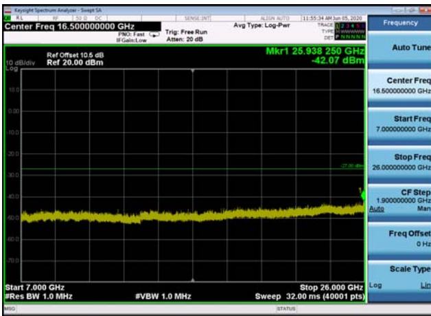
U-NII-1 ,Plot 4,7000MHz~26000MHz-802. 11ac(20MHz),5180MHz
