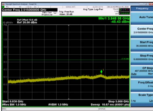
U-NII-1 ,Plot 2,30MHz~5000MHz-802.11a c(20MHz),5240MHz
