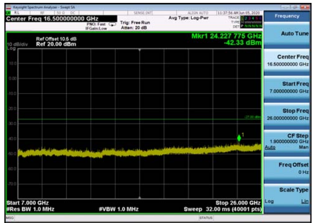
U-NII-1 ,Plot 4,7000MHz~26000MHz-802. 11a(20MHz),5240MHz
