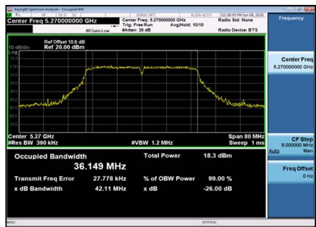
U-NII-2a 26dB Bandwidth-802.11ac(40MHz),5270MHz
