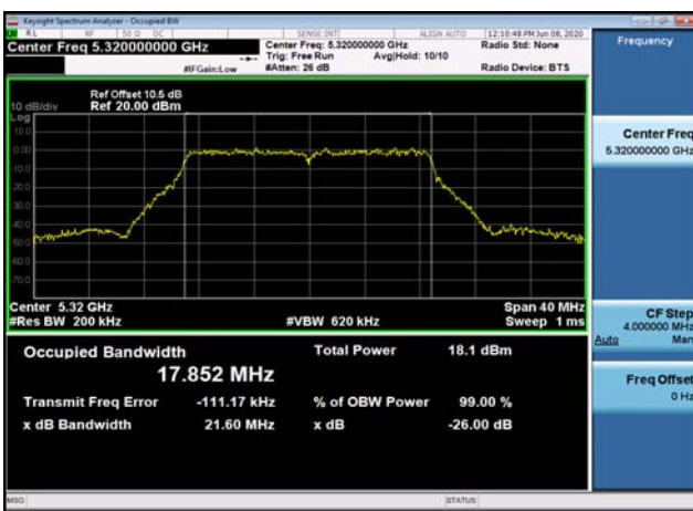
U-NII-2a 26dB Bandwidth-802.11ac(20MHz),5320MHz
