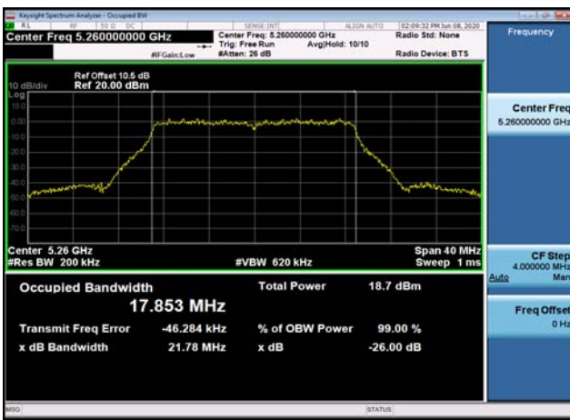
U-NII-2a 26dB Bandwidth-802.11ac(20MHz),5320MHz
