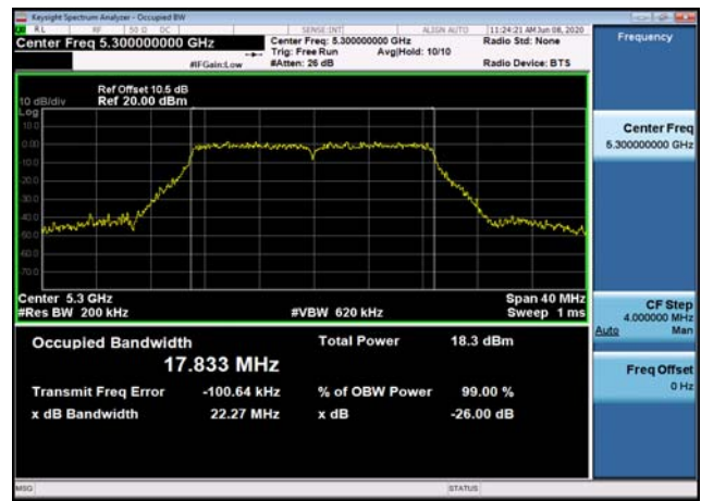
U-NII-2a 26dB Bandwidth-802.11n(40MHz),5270MHz
