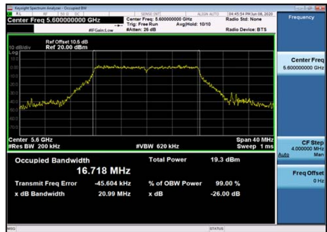
U-NII-2c 26dB Bandwidth-802.11ac(20MHz),5500MHz
