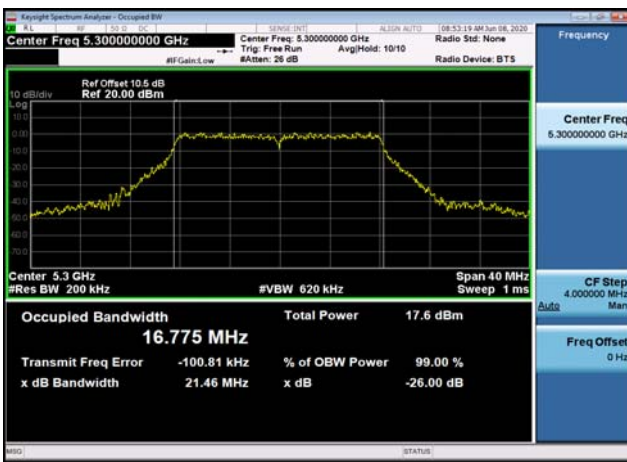
U-NII-2a 26dB Bandwidth-802.11ac(20MHz),5260MHz
