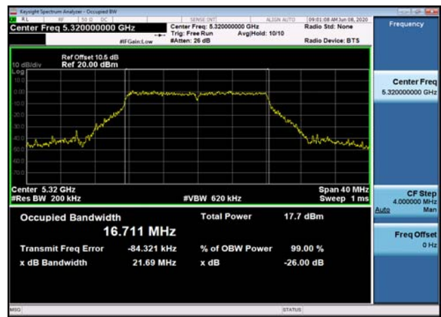
U-NII-2a 26dB Bandwidth-802.11ac(20MHz),5300MHz
