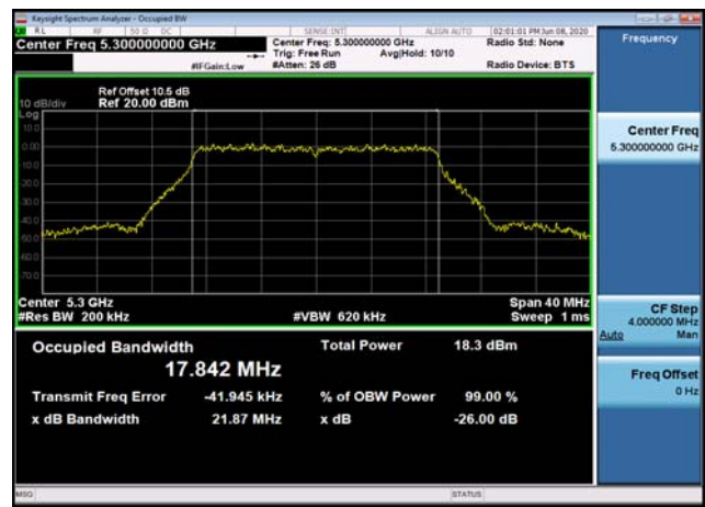
U-NII-2a 26dB Bandwidth-802.11ac(40MHz),5270MHz
