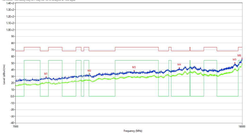
REmission Test case_FCC_Part 15E_FCC 15.407(5G)_6GHz-18GHz_B2
