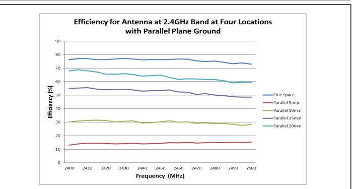
FIGURE 6.1.4 EFFICIENCY OF ANTENNA AT 2.4GHZ BAND AT FOUR LOCATIONS WITH PARALLEL PLANE GROUND
