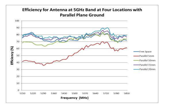
FIGURE 6.1.5 EFFICIENCY OF ANTENNA AT 5GHZ BAND AT FOUR LOCATIONS WITH PARALLEL PLANE GROUND
