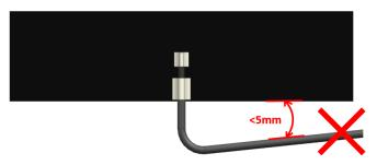
FIGURE 5.2.2 UNRECOMMENDED CABLE BENDING RANGE
