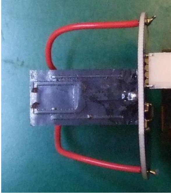
Bottom dipole antenna
