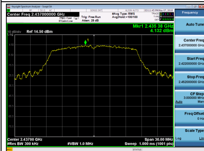
802.11g - AV Output power - Mid CH 2437
