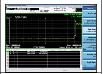
$\pi/4DQPSK$  No-Hopping Band edge-Left side
