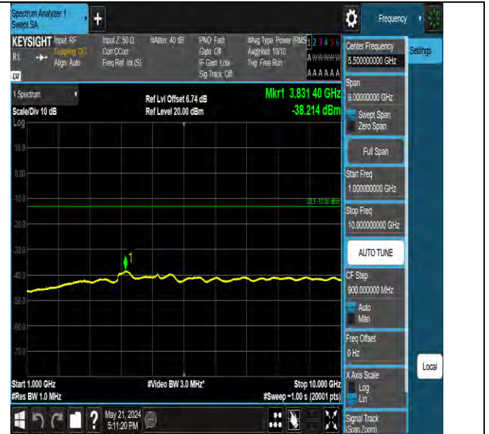
Band13 5MHz QPSK 23205 1RB#0 1000~10000 1000~10000
