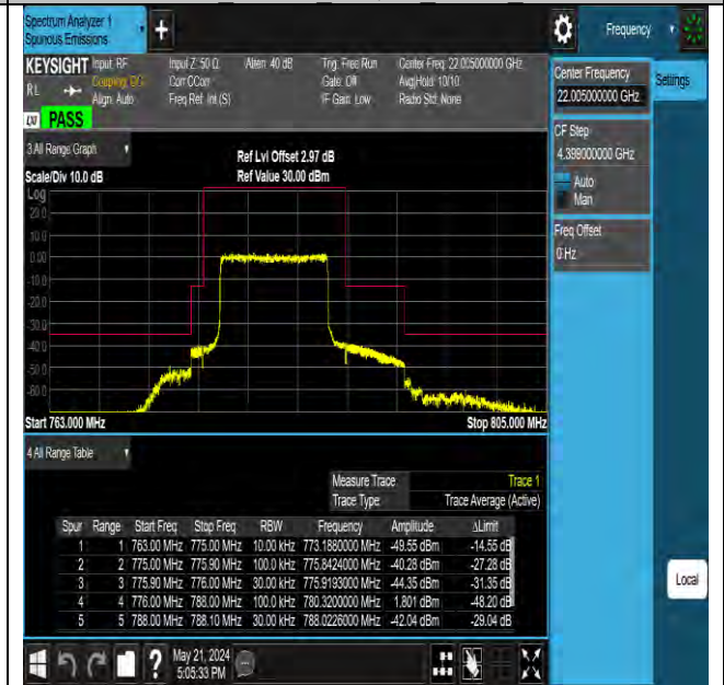
Band13 10MHz 16QAM 23230 50RB#0
