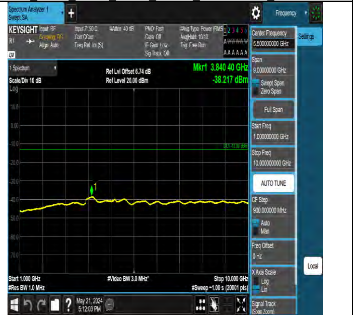
Band13 5MHz QPSK 23230 1RB#0 1000~10000 1000~10000
