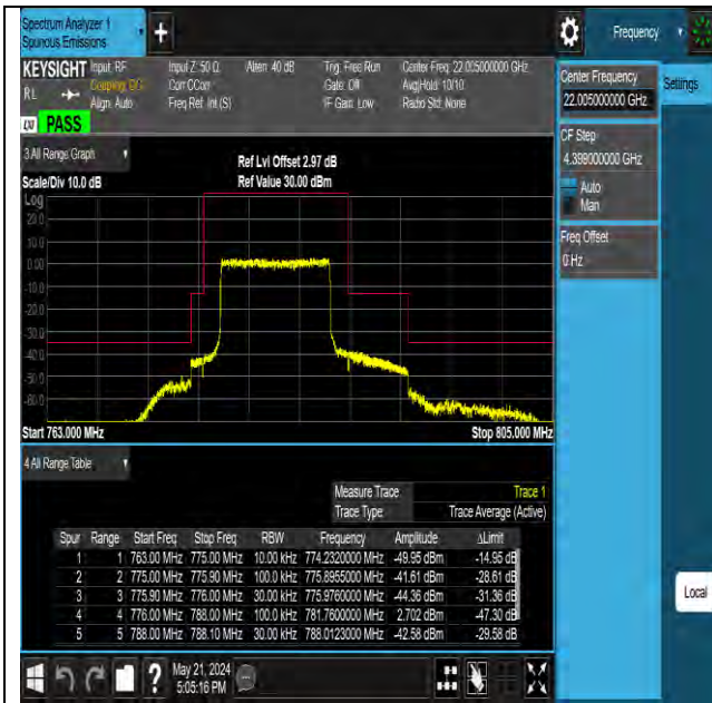
Band13 10MHz QPSK 23230 50RB#0
