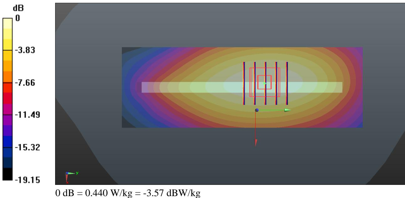
**24\_LTE Band 7\_20M\_QPSK\_1RB\_49Offset\_Back\_10mm\_Ch20850**
