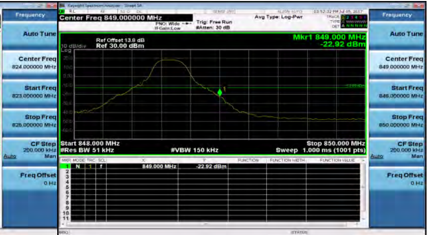
Band Edge_Band5 5MHz_QPSK 25 0_LowCH20425-826.5
