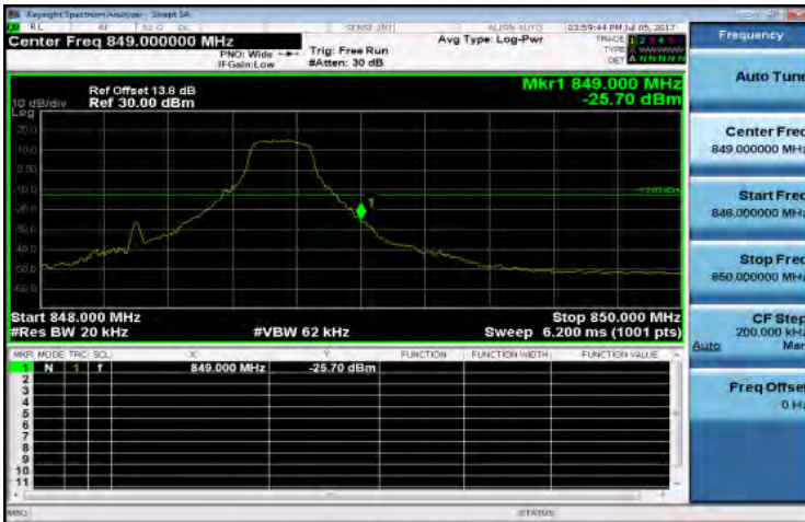
Band Edge_Band5 1.4MHz_QPSK 6 0_LowCH20407-824.7
