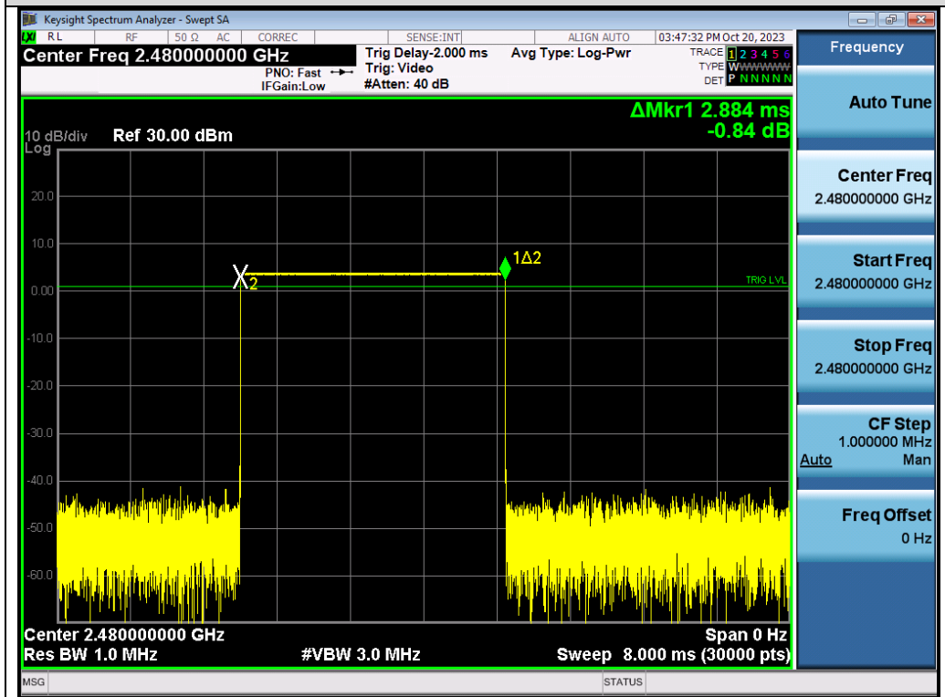
Test_Graph_BR_HOP_ANT1_NA_1Mbps_2480_Time per Burst
