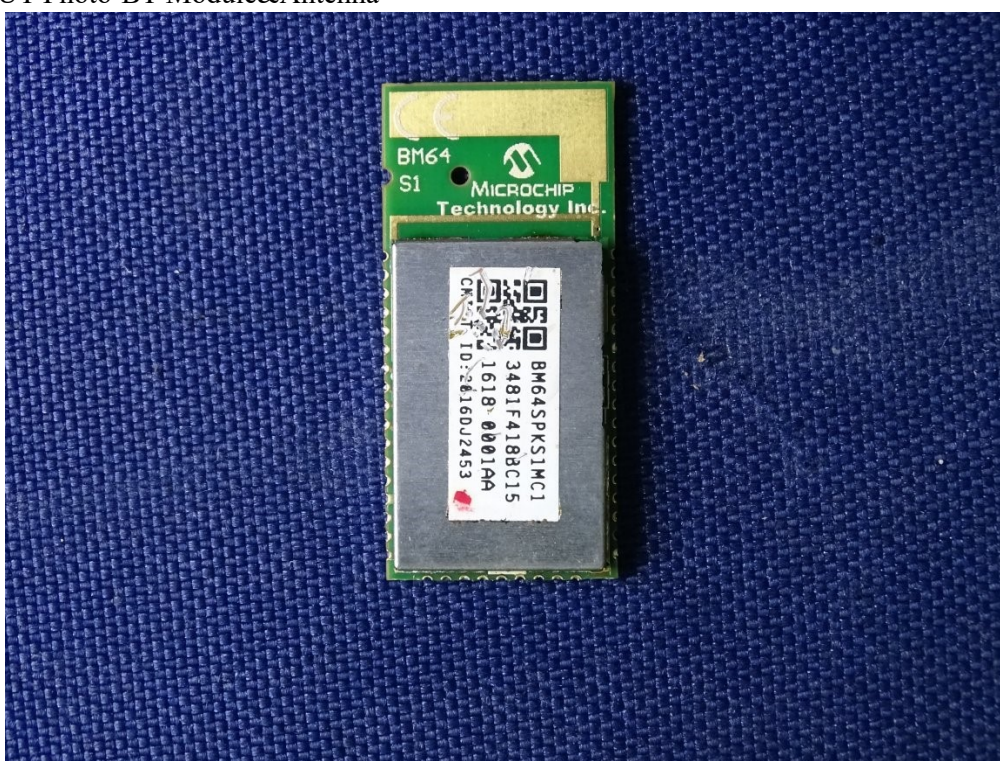
(18) EUT Photo-BT Module&Antenna
