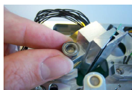
Rillenkugellager entnehmen remove the ball bearing
