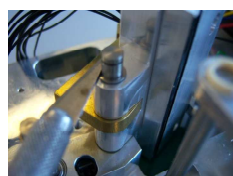
Sicherungsring mit W.3 entfernen remove the circlip with W.3
