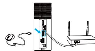
3. Conecte el NVR al monitor con un cable HDMI. (Opcional, si desea monitorear en una pantalla)
