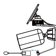
6. Collegare l'adattatore magnetico alla porta magnetica del pannello solare.
