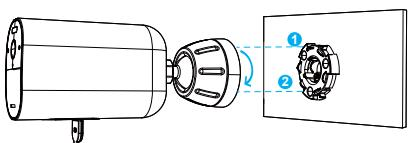
6. Stringere la vite di bloccaggio sul supporto di montaggio, e poi regolare all'angolo di cui si ha bisogno.
