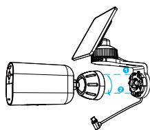
5. Avitare la vite di bloccaggio sul supporto di montaggio, regolare l'angolo desiderato e collegare il cavo di estensione magnetico.
