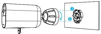
6. Apriete el tornillo de bloqueo en el soporte de montaje y luego ajústelo al ángulo que necesite.
