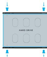
4. Inserte y atornille la abrazadera de vuelta al NVR, luego coloque la tapa inferior de nuevo en su lugar.
