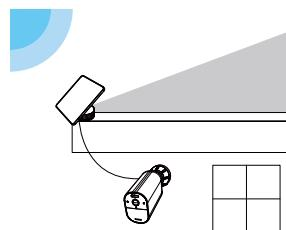
1. Desmontar el soporte de montaje del panel solar.
