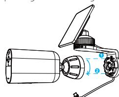
5. Apriete el tornillo de bloqueo en el soporte de montaje, ajuste a la ángulo que necesita y conecte el cable de extensión magnética.
