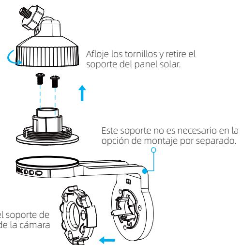
2. Instale el soporte de montaje del panel solar en una posición adecuada.
