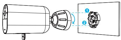
6. Serrez la vis de blocage sur le support de montage, puis ajustez à l'angle dont vous avez besoin.
