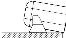
Il supporto di fissaggio per la fotocamera può essere utilizzato per il posizionamento e la regolazione degli angoli in alcuni scenari.
