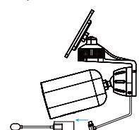
6. Conecte el adaptador magnético al puerto magnético del panel solar.
