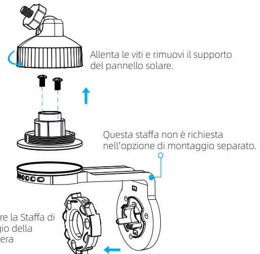
2. Installa il supporto di montaggio del pannello solare in una posizione adatta.
