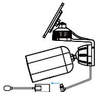
6. Verbinden Sie den Magnetadapter mit dem Magnetanschluss des Solarpanels.
