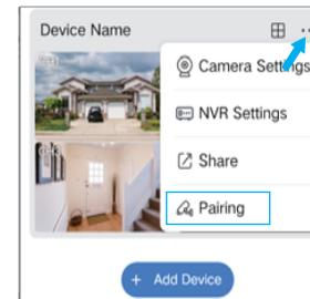
Drücken Sie die Zurücksetzen-Taste der Kamera dreimal innerhalb von drei Sekunden, um die Paarung mit dem NVR zu starten. Auf dem Bildschirm sollte die Meldung "Pairing erfolgreich" erscheinen. Falls Sie diese Meldung nicht sehen, wiederholen Sie die oben genannten Schritte.
