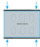
4. Insérez et vissez le support à nouveau sur le NVR, puis remettez le couvercle inférieur en place.
