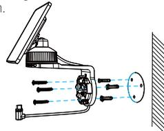
4. Installieren Sie die Kamera auf ihrer Montagehalterung, indem Sie sie im Uhrzeigersinn drehen, bis sie einrastet.
