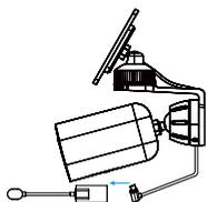
6. Connectez l'adaptateur magnétique à la porte magnétique du panneau solaire.
