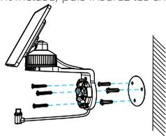
4. Installez la caméra sur son support de montage en la tournant dans le sens des aiguilles d'une montre jusqu'à ce qu'elle se verrouille en place par un clic.
