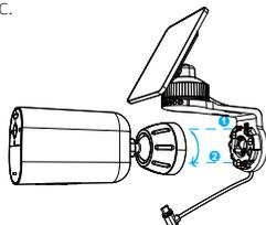
5. Serrez la vis de verrouillage sur le support de montage, ajustez-le à l'angle souhaité et connectez le cordon de prolongation magnétique.
