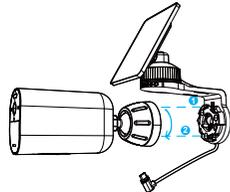
5. Die Verschraubung auf dem Montagehalter festziehen, an den gewünschten Winkel einstellen und das magnetische Verlängerungskabel anschließen.
