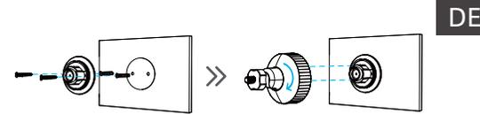
3. Installieren Sie das Solarmodul auf seinem Halterungswinkel, indem Sie es drehen, und justieren Sie dann den Winkel.
