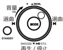
このコントロールする機能は、AVRCP プロファイル対応機器との接続時に機能します。
