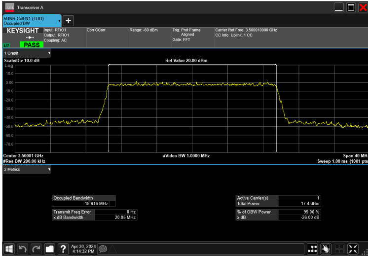
20MHz_15kHz_3500MHz_CP-OFDM QPSK_RB106@0 18.916 MHz
