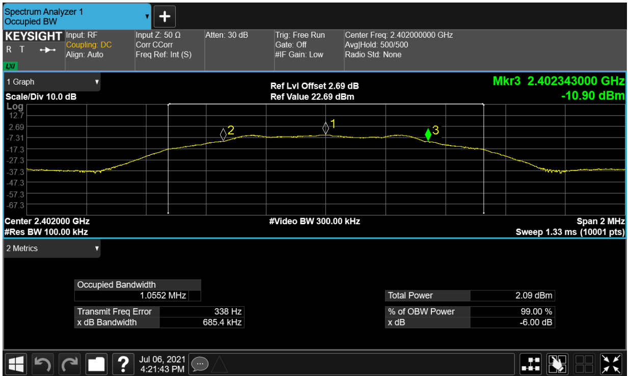
-6dB Bandwidth NVNT BLE 2442MHz Ant1
