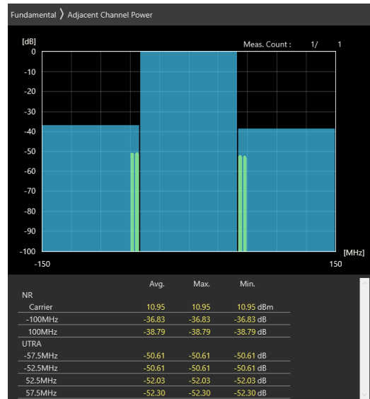
100MHz_30kHz_3600MHz_DFT-s-OFDM \pi/2 BPSK_RB135@67 -36.85 dB,-38.79 dB
