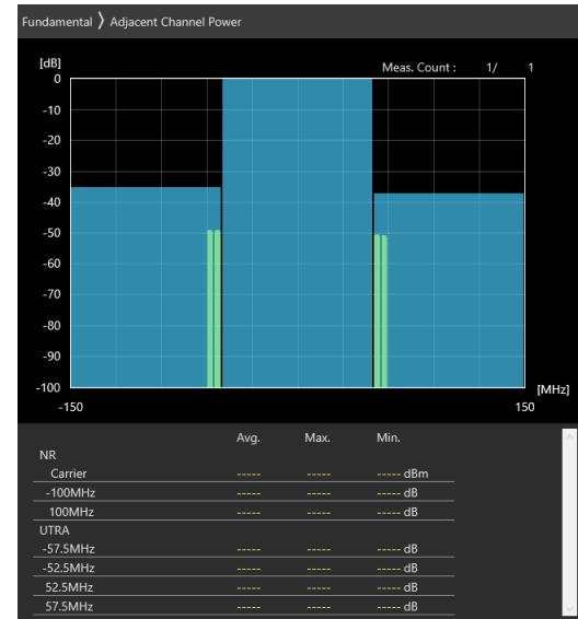
100MHz_30kHz_3650MHz_CP-OFDM QPSK_RB137@68 -35.32 dB,-37.37 dB
