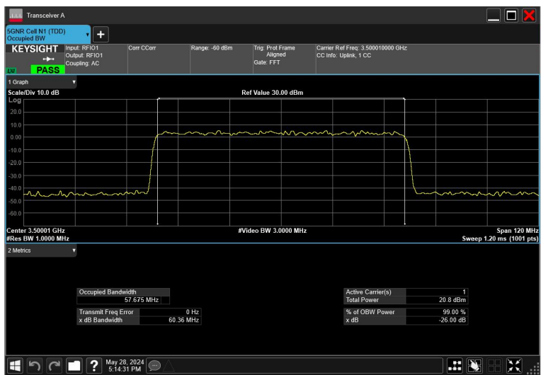
60MHz_30kHz_3500MHz_DFT-s-OFDM \pi/2 BPSK_RB162@0
