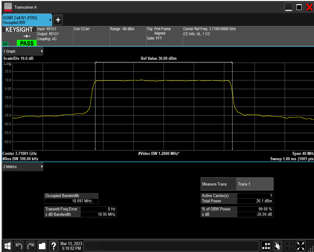
n77(3700-3980) SCS=30kHz DFT_QAM16 BW=20MHz Channel=647334 RB=50@0
