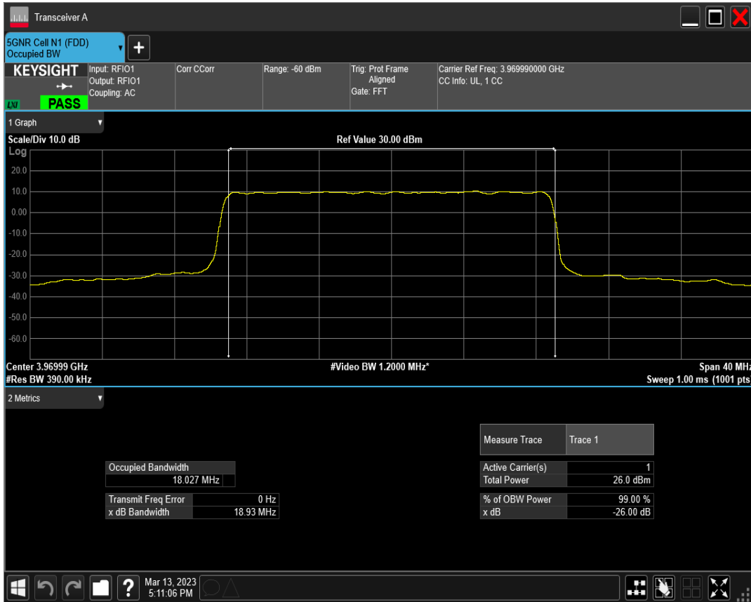
n77(3700-3980) SCS=30kHz DFT_QAM16 BW=20MHz Channel=664666 RB=50@0
