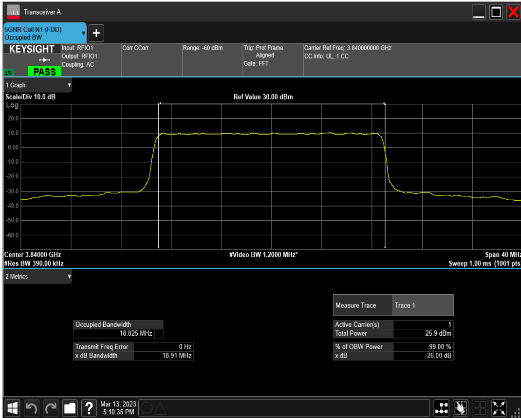
n77(3700-3980) SCS=30kHz DFT_QAM16 BW=20MHz Channel=656000 RB=50@0
