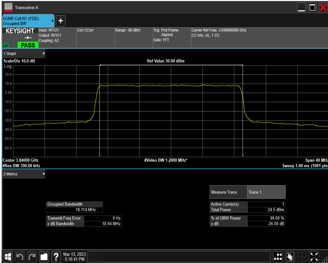
n77(3700-3980) SCS=30kHz DFT_QAM256 BW=20MHz Channel=656000 RB=50@0
