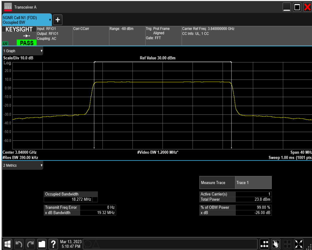
n77(3700-3980) SCS=30kHz DFT_BPSK BW=20MHz Channel=664666 RB=50@0
