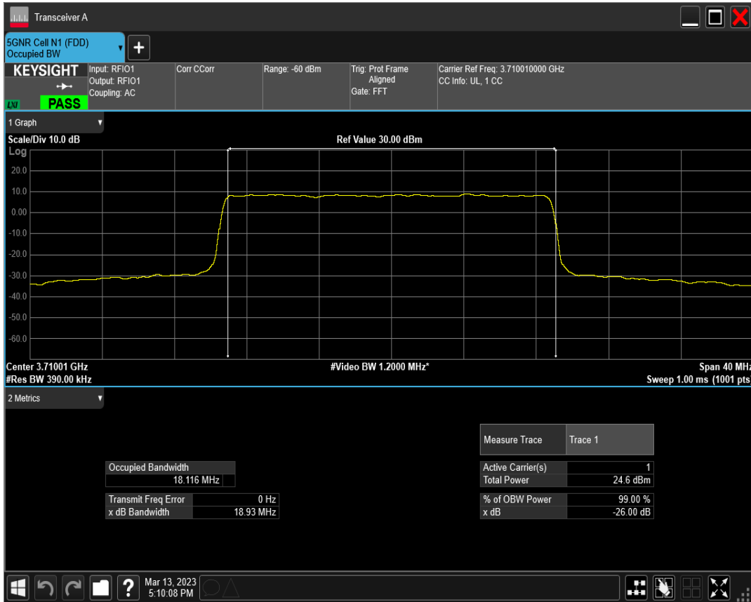
n77(3700-3980) SCS=30kHz DFT_QAM256 BW=20MHz Channel=647334 RB=50@0
