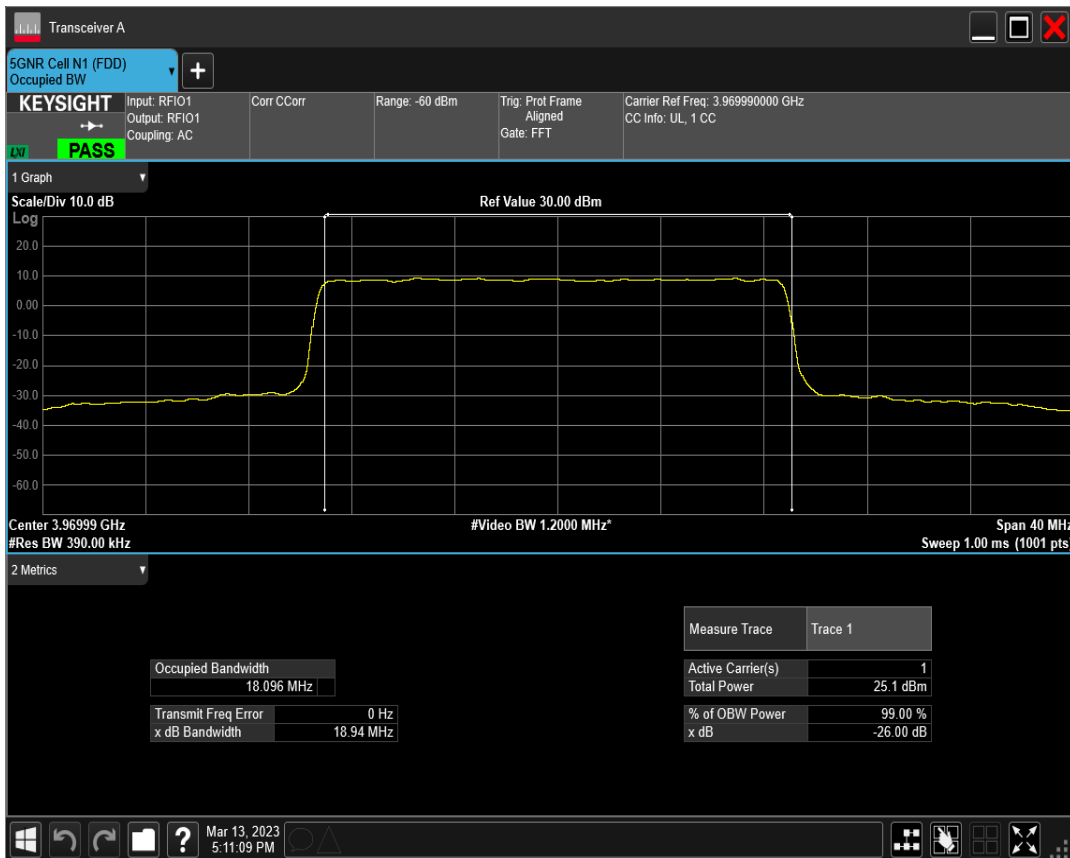
n77(3700-3980) SCS=30kHz DFT_QAM64 BW=20MHz Channel=664666 RB=50@0
