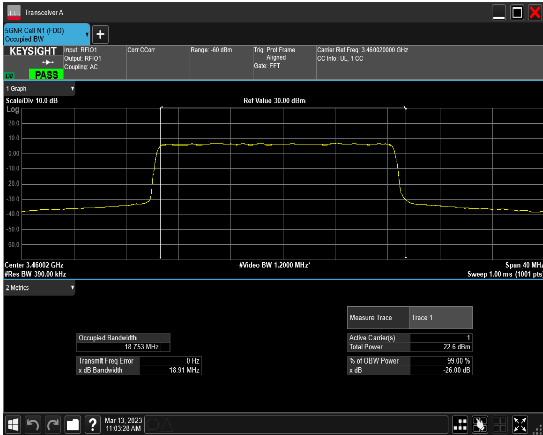
n77(3450-3550) SCS=15kHz CP_QPSK BW=20MHz Channel=630668 RB=106@0
