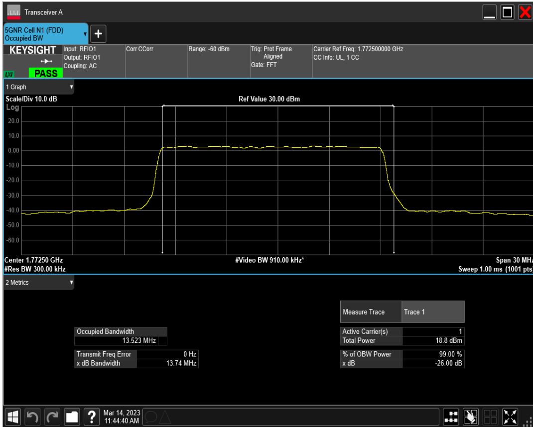
n66 SCS=30kHz CP_QPSK BW=15MHz Channel=354500 RB=38@0
