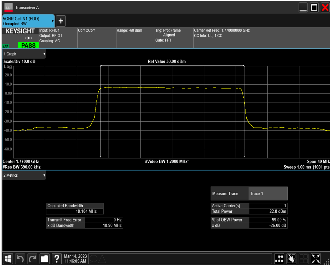
n66 SCS=30kHz DFT_QPSK BW=20MHz Channel=354000 RB=50@0
