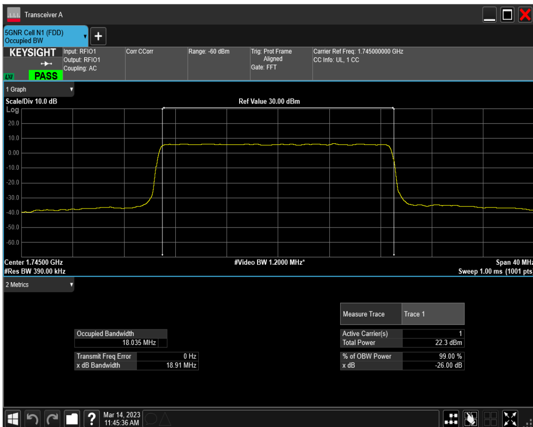
n66 SCS=30kHz DFT_QAM16 BW=20MHz Channel=349000 RB=50@0
