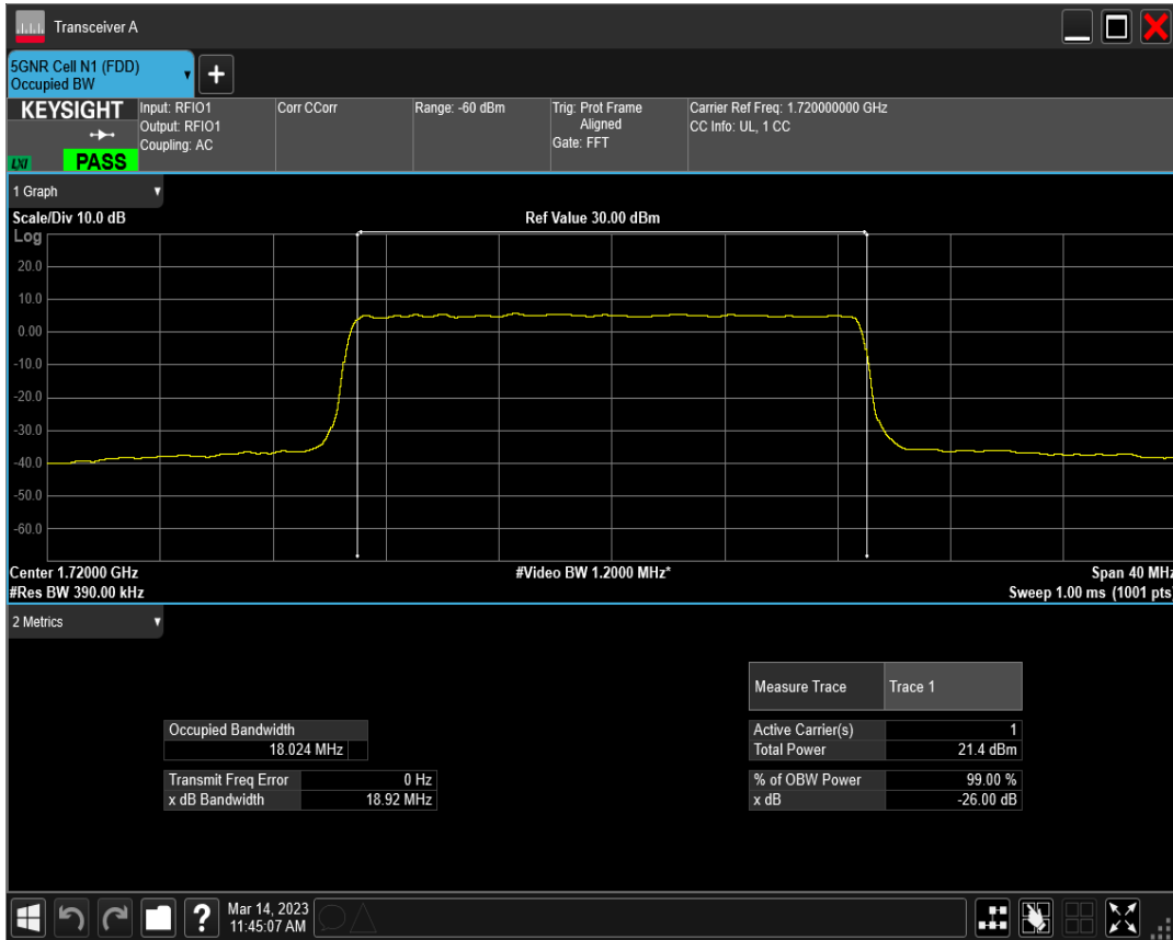
n66 SCS=30kHz DFT_QAM64 BW=20MHz Channel=344000 RB=50@0
