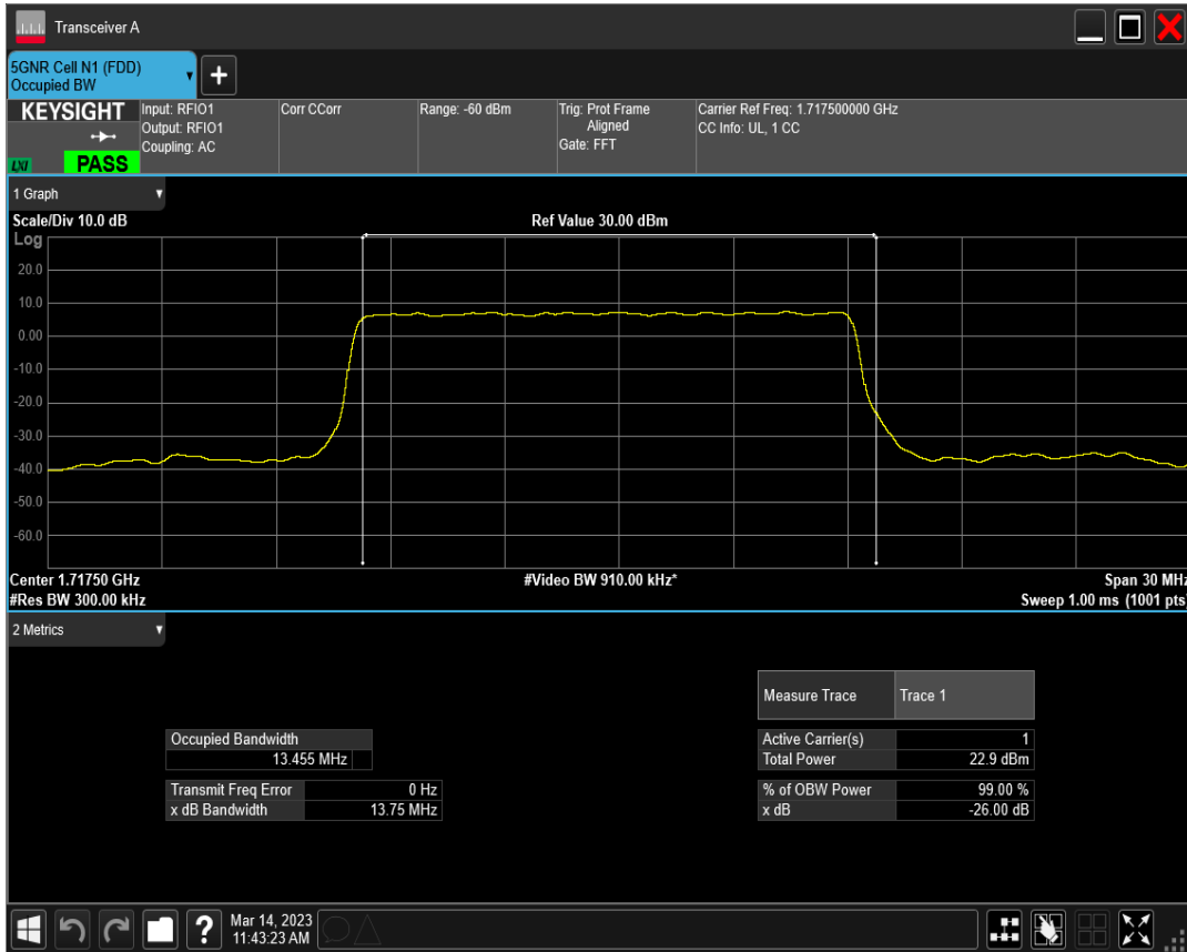
n66 SCS=30kHz DFT_QPSK BW=15MHz Channel=343500 RB=36@0
