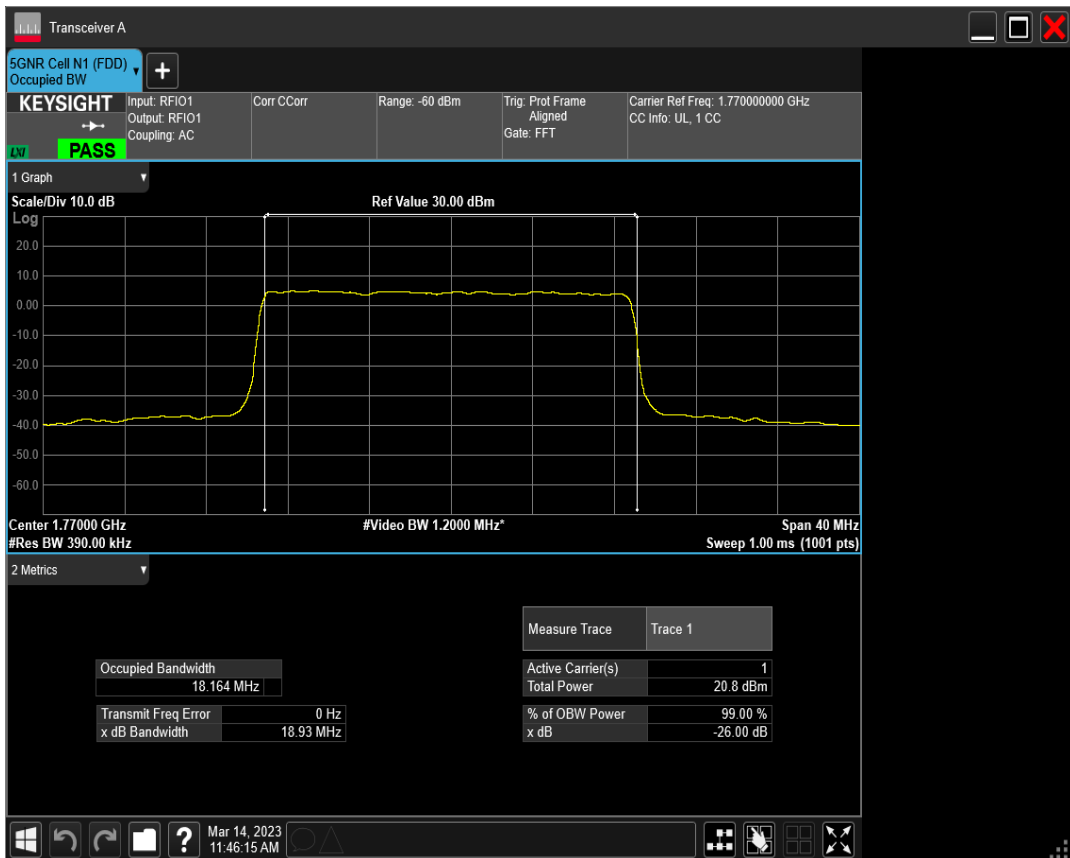
n66 SCS=30kHz DFT_QAM256 BW=20MHz Channel=354000 RB=50@0
