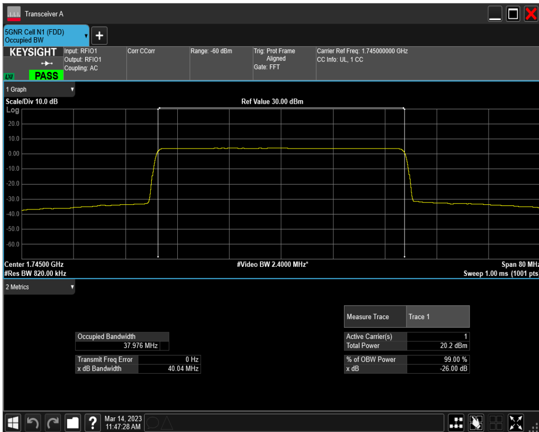
n66 SCS=30kHz DFT_BPSK BW=40MHz Channel=352000 RB=100@0
