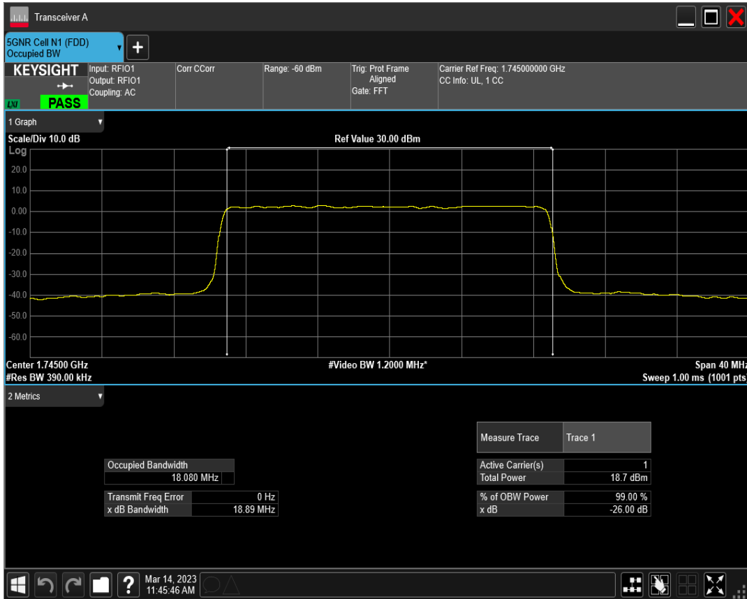
n66 SCS=30kHz CP_QPSK BW=20MHz Channel=349000 RB=51 @0
