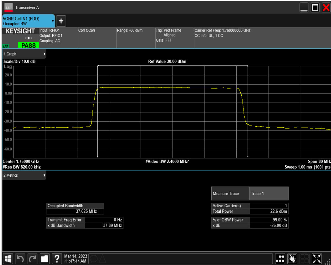
n66 SCS=30kHz DFT_QPSK BW=40MHz Channel=352000 RB=100@0
