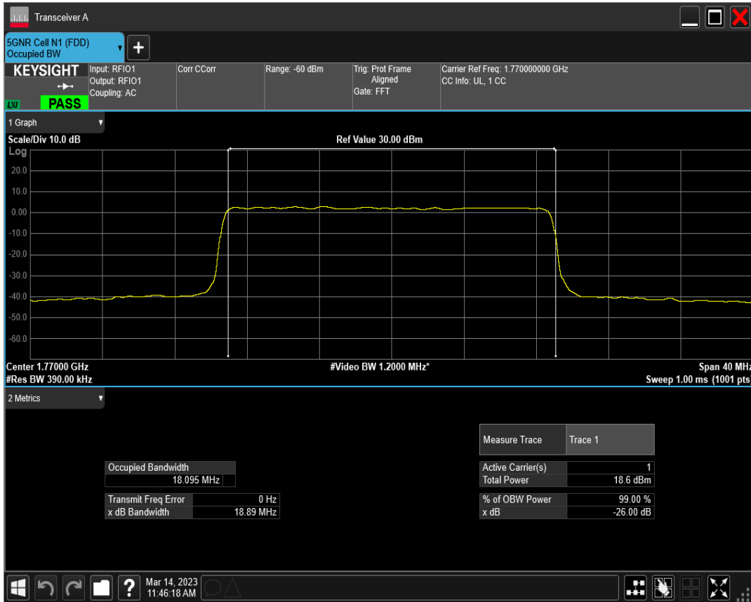
n66 SCS=30kHz CP_QPSK BW=20MHz Channel=354000 RB=51@0
