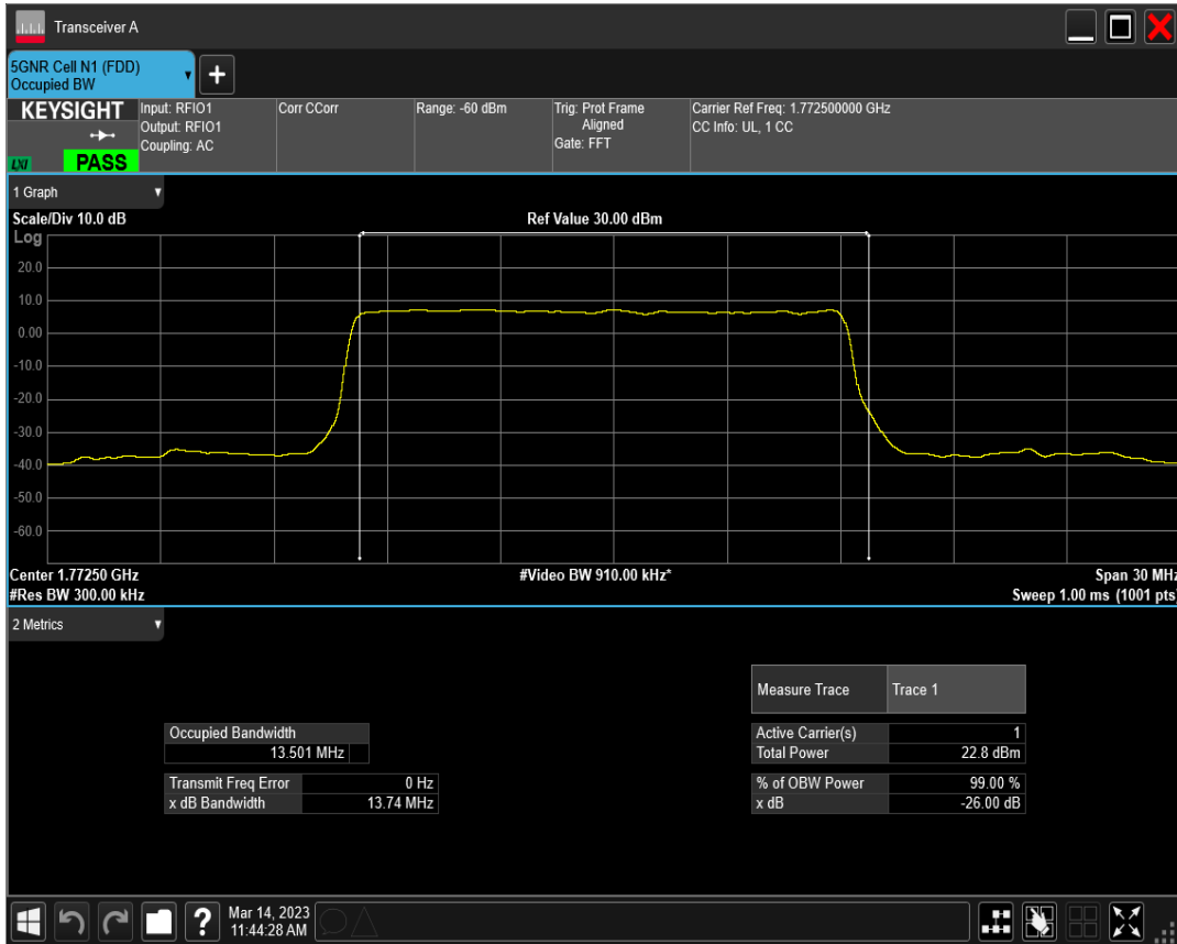
n66 SCS=30kHz DFT_QPSK BW=15MHz Channel=354500 RB=36@0
