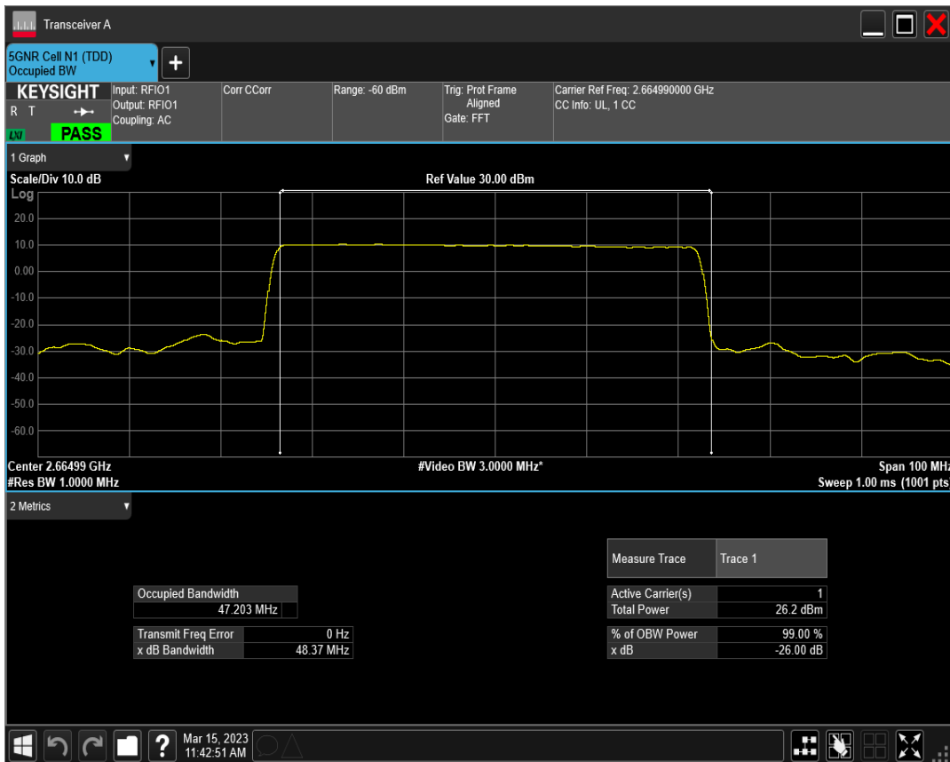
n41 SCS=30kHz DFT_QPSK BW=50MHz Channel=532998 RB=128@0
