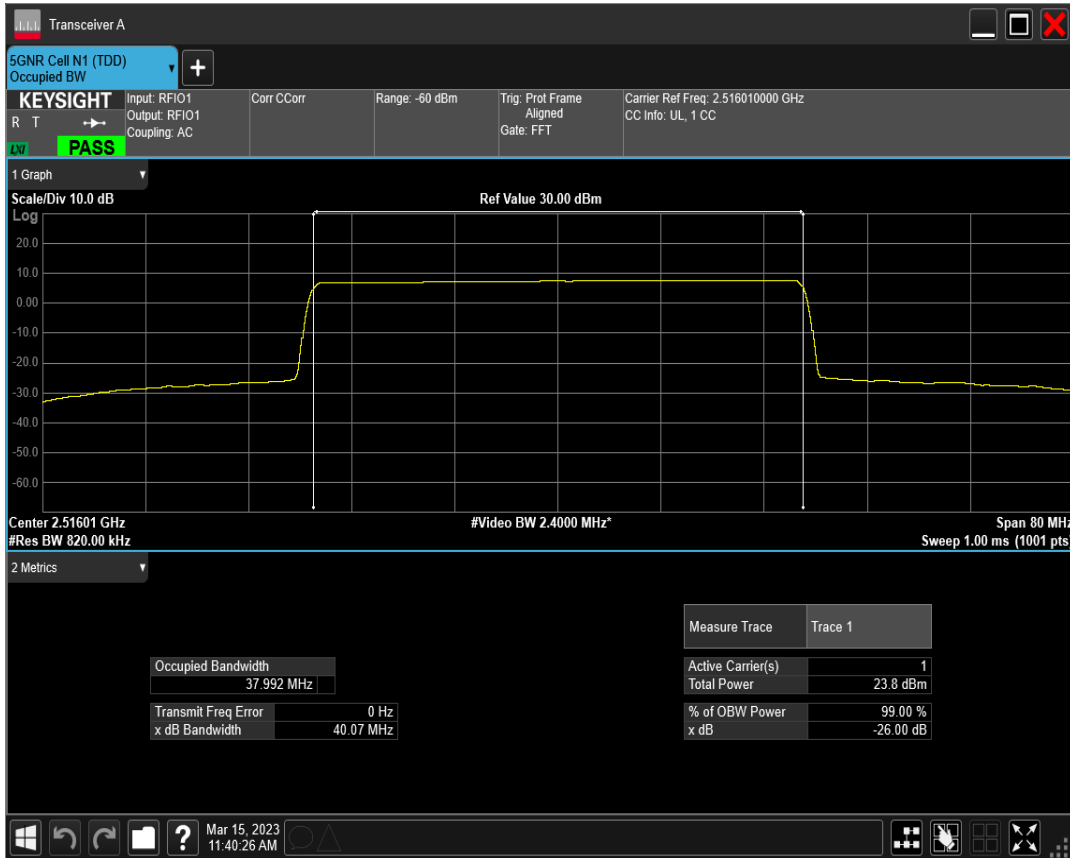
n41 SCS=30kHz DFT_BPSK BW=40MHz Channel=518598 RB=100@0
