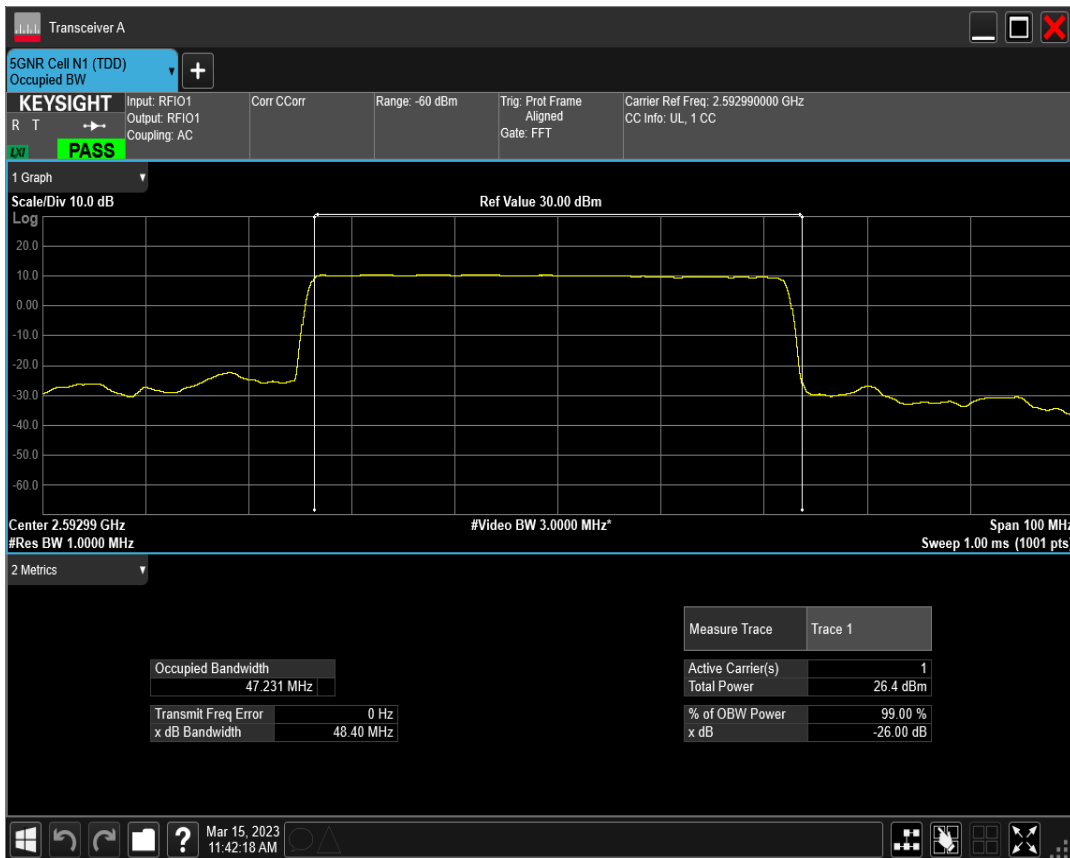
n41 SCS=30kHz DFT_QPSK BW=50MHz Channel=518598 RB=128@0
