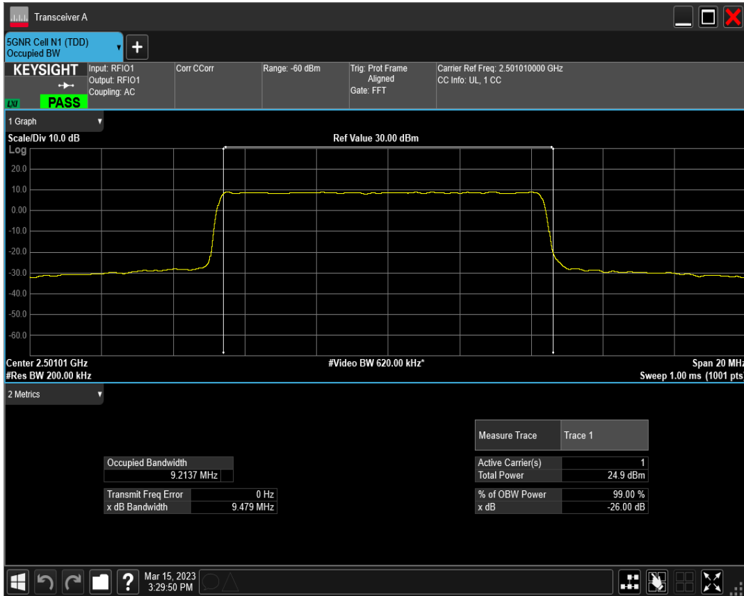
n41 SCS=15kHz DFT_QAM64 BW=10MHz Channel=500202 RB=50@0
