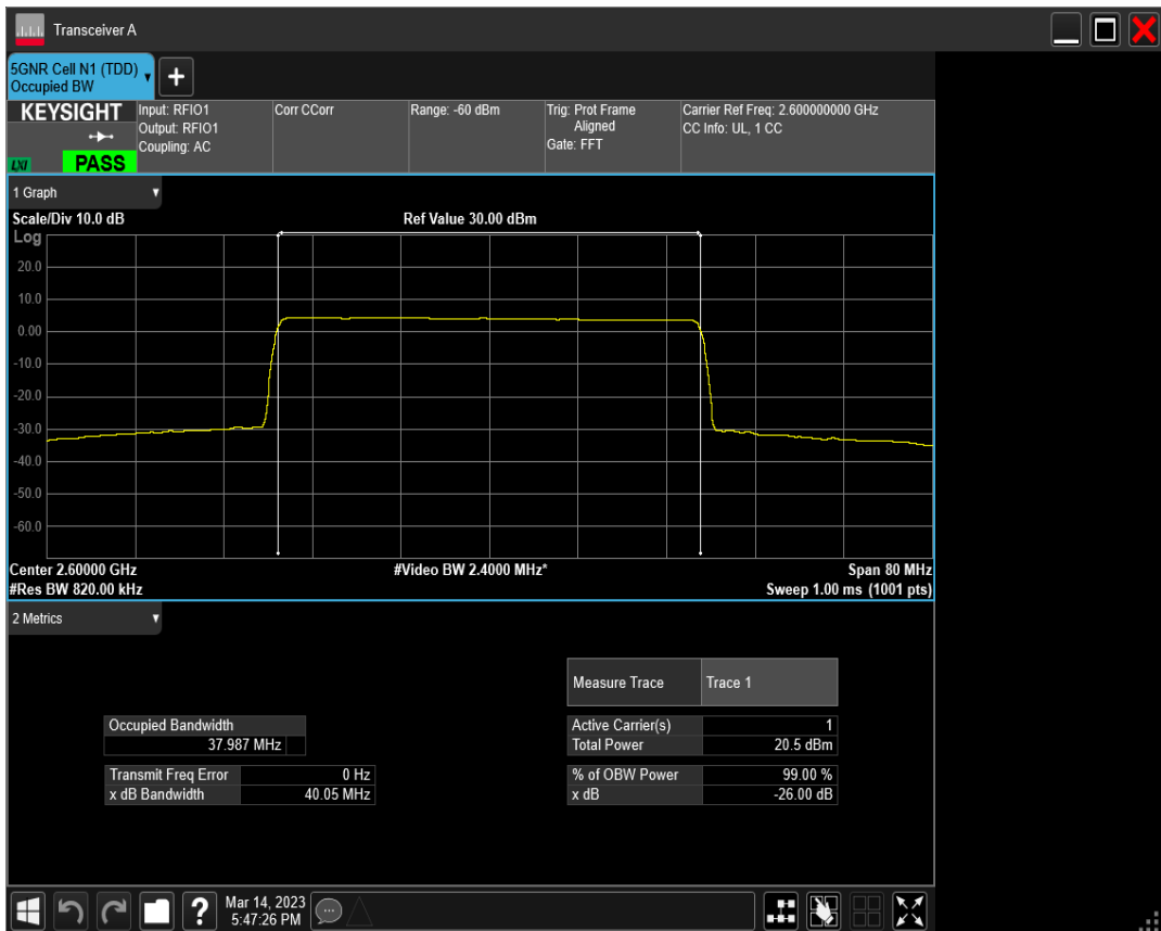
n38 SCS=30kHz CP_QPSK BW=40MHz Channel=520000 RB=106@0
