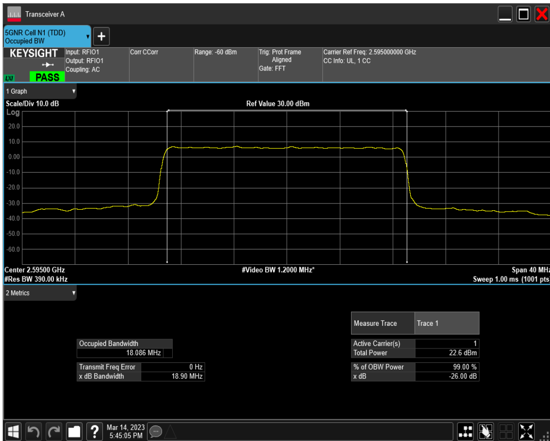
n38 SCS=30kHz DFT_QAM16 BW=20MHz Channel=519000 RB=50@0
