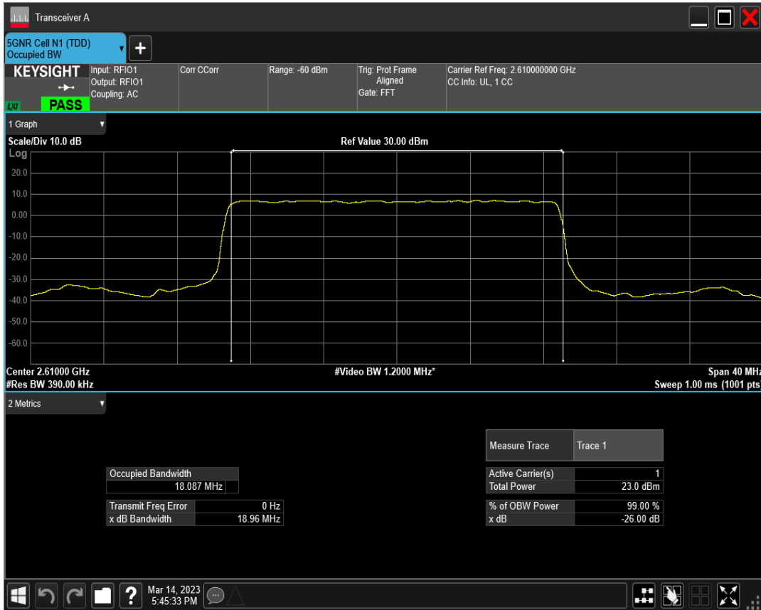
n38 SCS=30kHz DFT_QPSK BW=20MHz Channel=522000 RB=50@0
