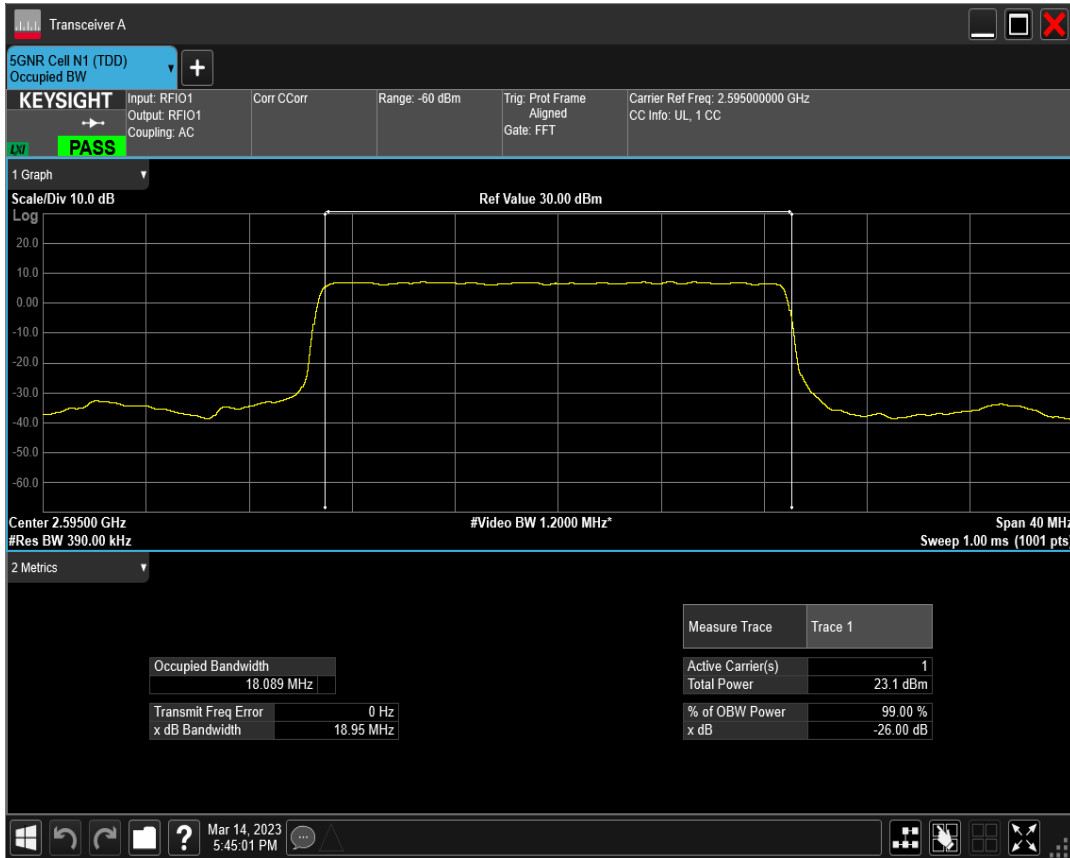
n38 SCS=30kHz DFT_QPSK BW=20MHz Channel=519000 RB=50@0
