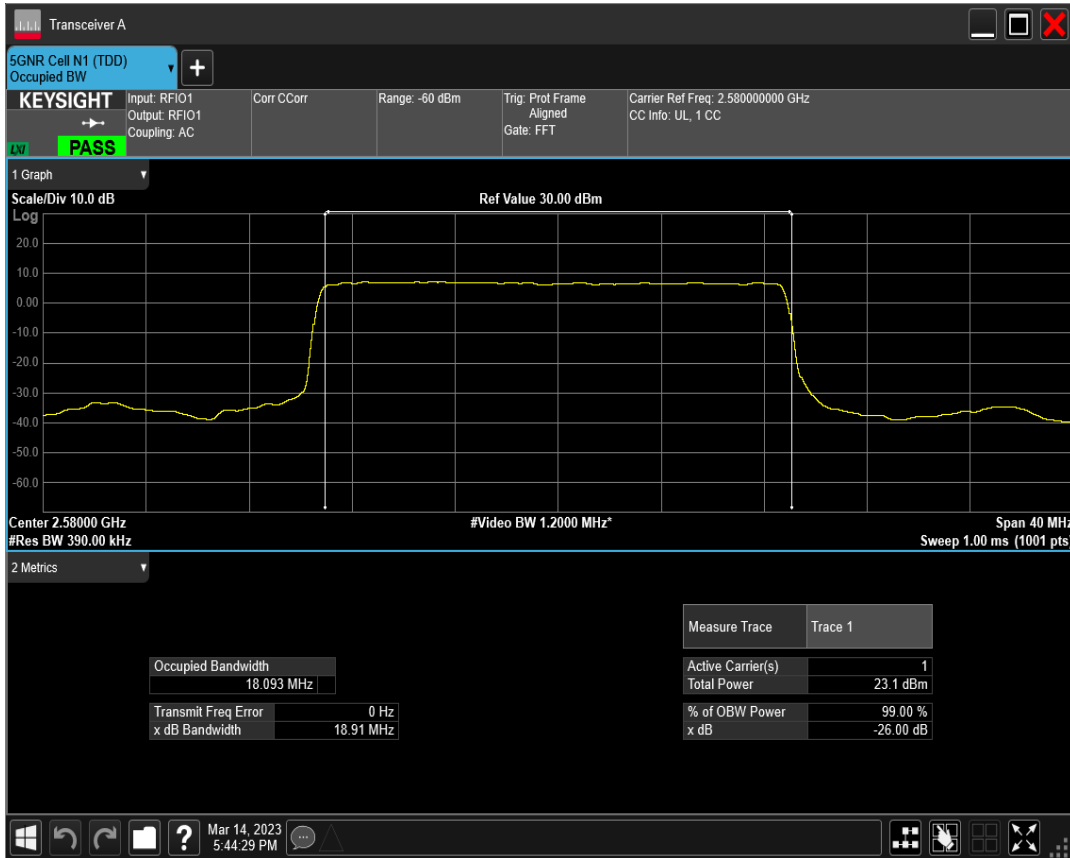
n38 SCS=30kHz DFT_QPSK BW=20MHz Channel=516000 RB=50@0
