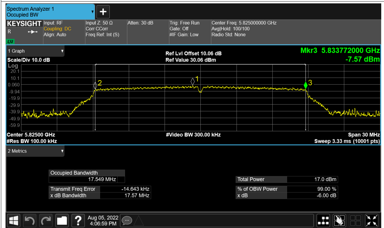
-6dB Bandwidth NVNT ac40 5755MHz Ant1
