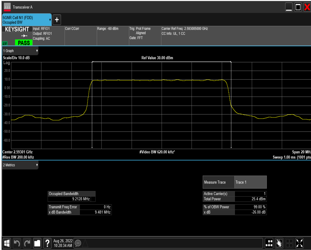
n41 SCS=15kHz DFT_QPSK BW=10MHz Channel=518601 RB=50@0
