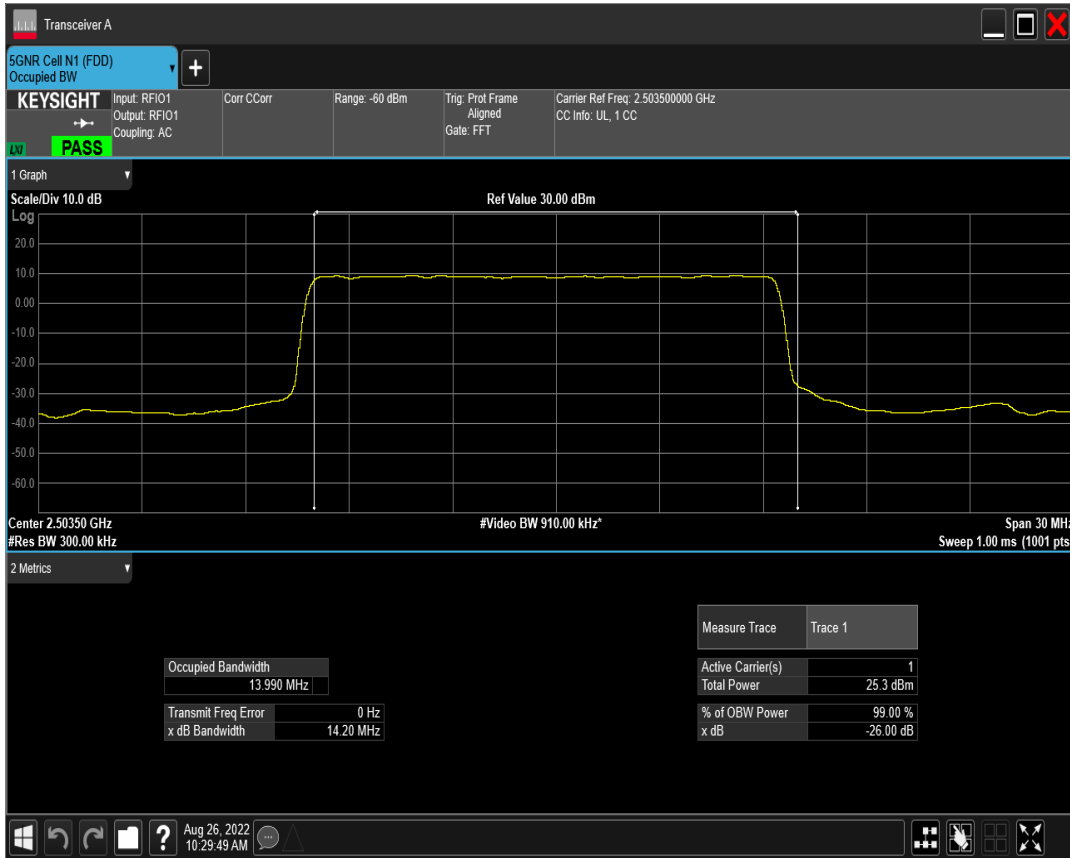
n41 SCS=15kHz DFT_QPSK BW=15MHz Channel=500700 RB=75@0
