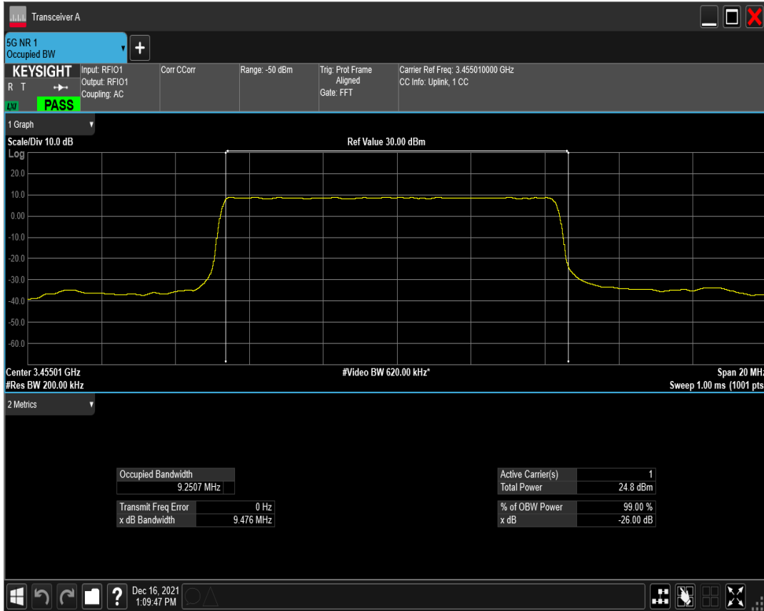
n77(3450-3550) SCS=15kHz DFT_QPSK BW=10MHz Channel=630334 RB=50@0
