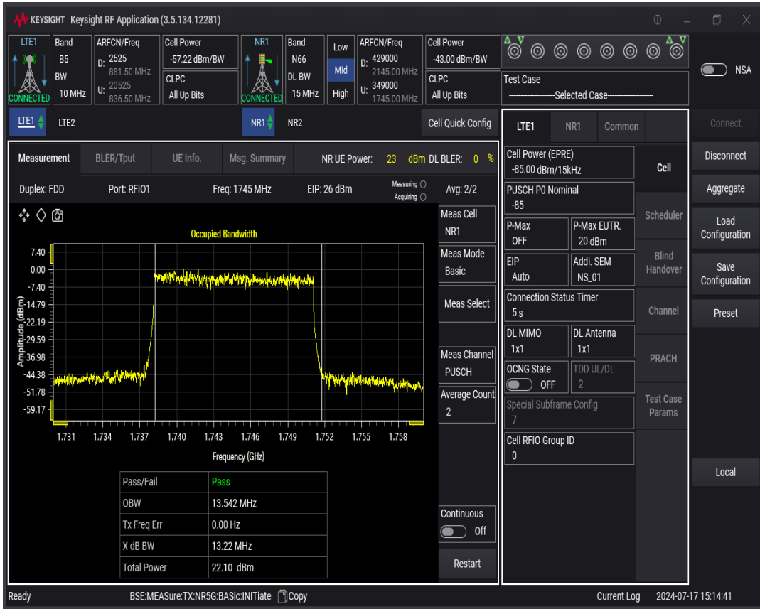
n66 SCS=30kHz DFT_QAM64 BW=20MHz Channel=349000 RB=50@0
