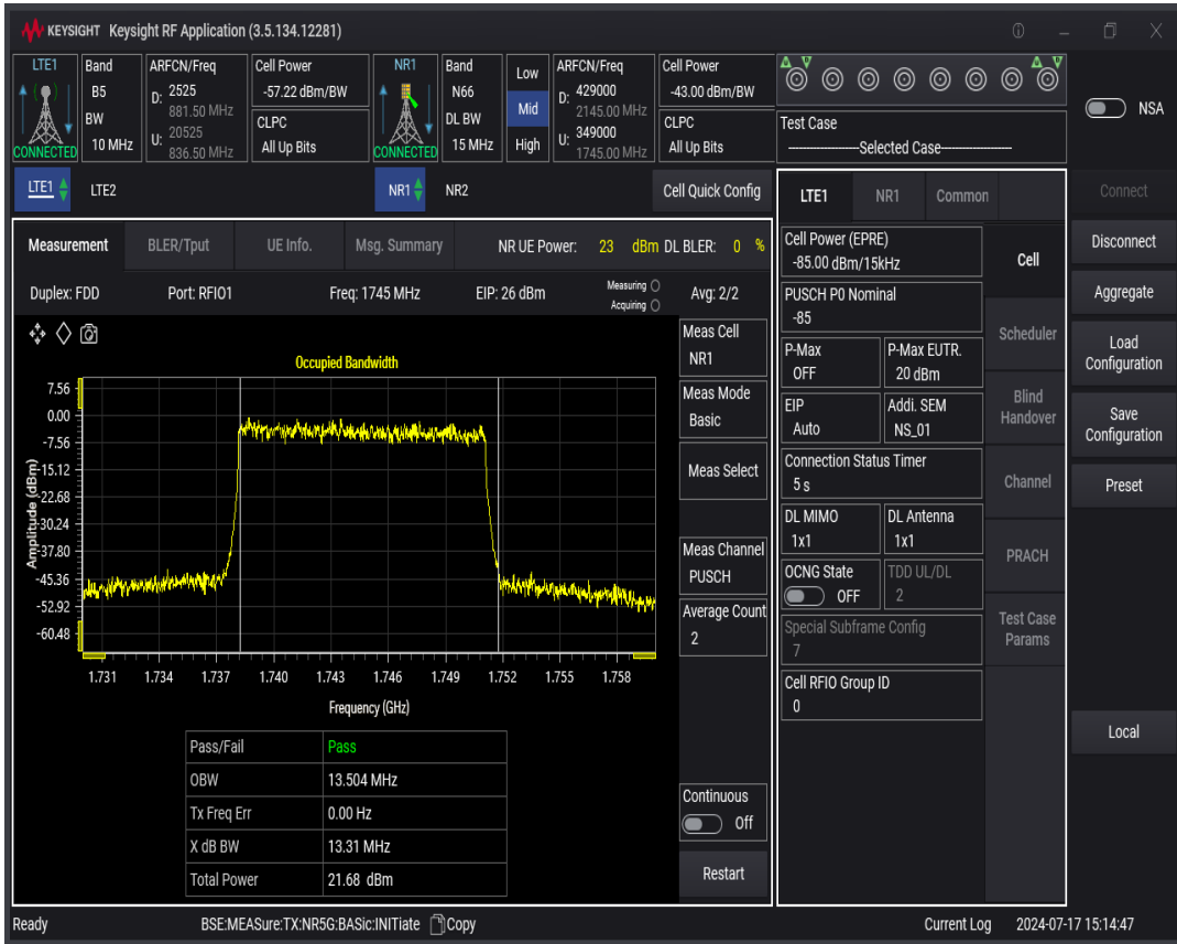
n66 SCS=30kHz DFT_QAM256 BW=20MHz Channel=349000 RB=50 @0
