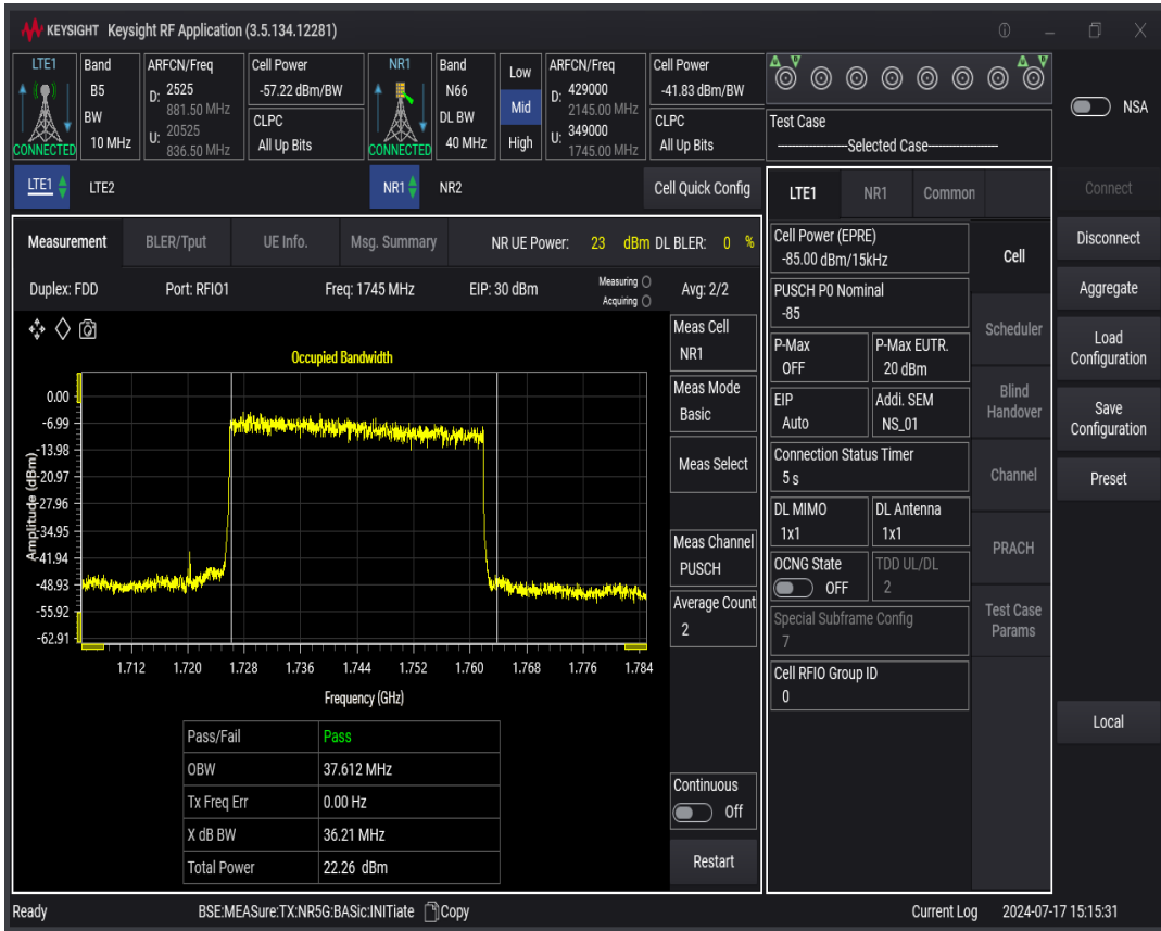
n66 SCS=30kHz DFT_QPSK BW=40MHz Channel=349000 RB=100@0
