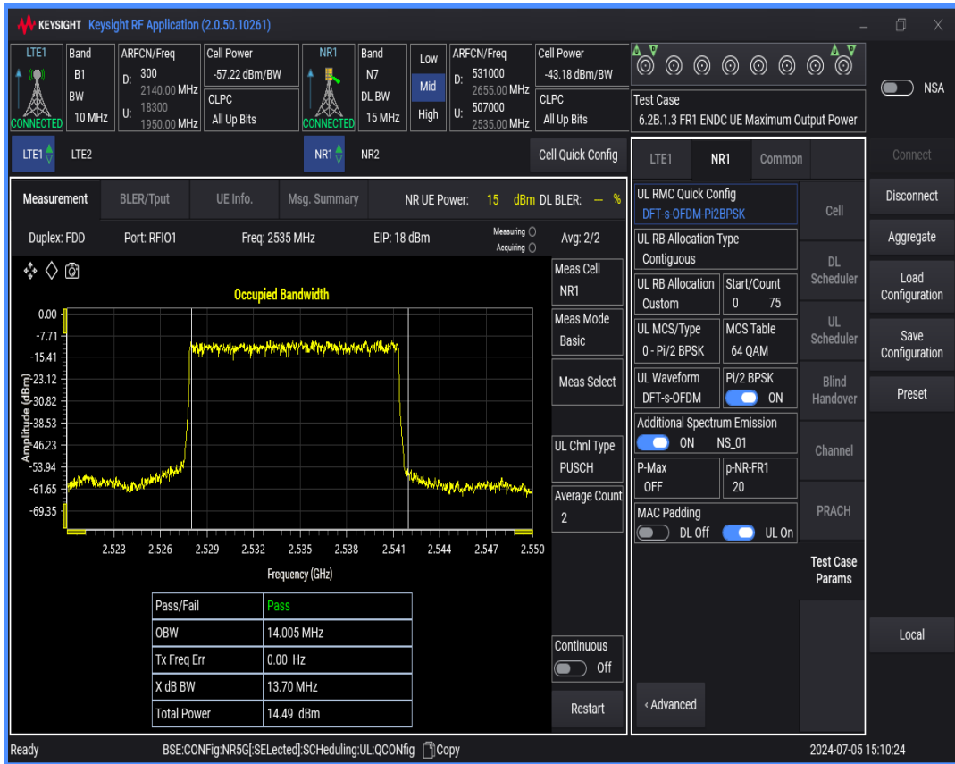
n7 SCS=15kHz DFT_BPSK BW=20MHz Channel=507000 RB=100 @0
