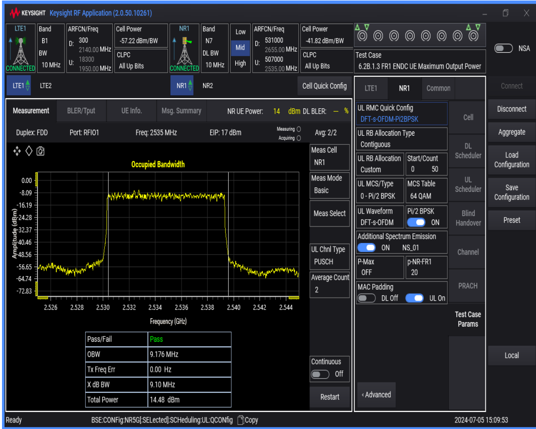
n7 SCS=15kHz DFT_BPSK BW=15MHz Channel=507000 RB=75 @0
