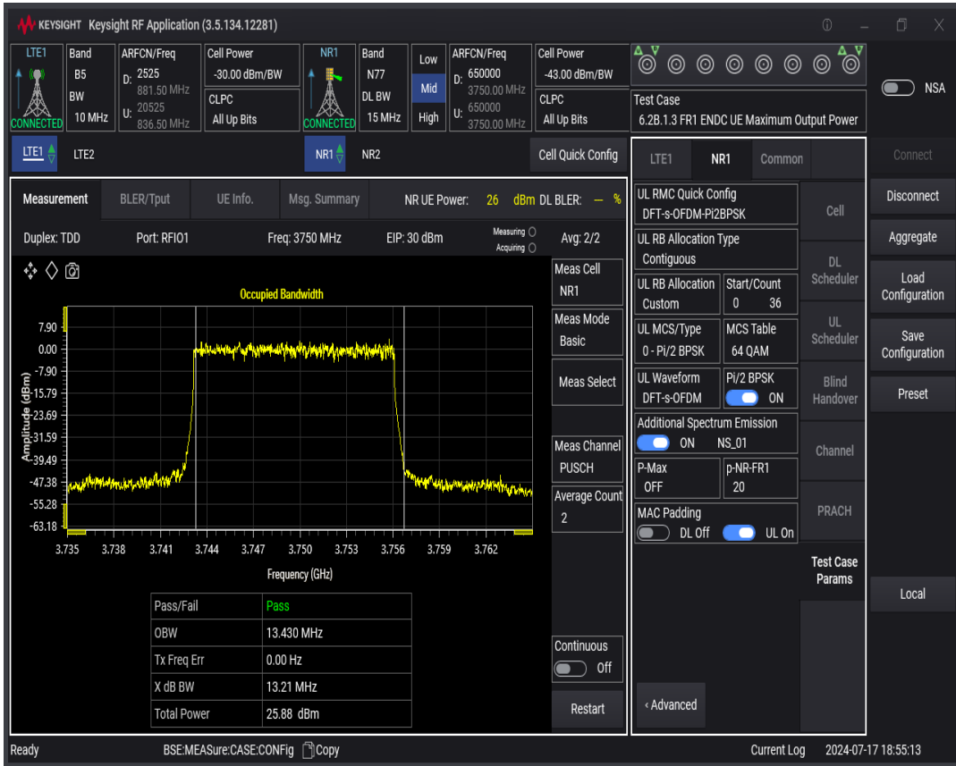
n77 SCS=30kHz DFT_BPSK BW=20MHz Channel=650000 RB=50@0
