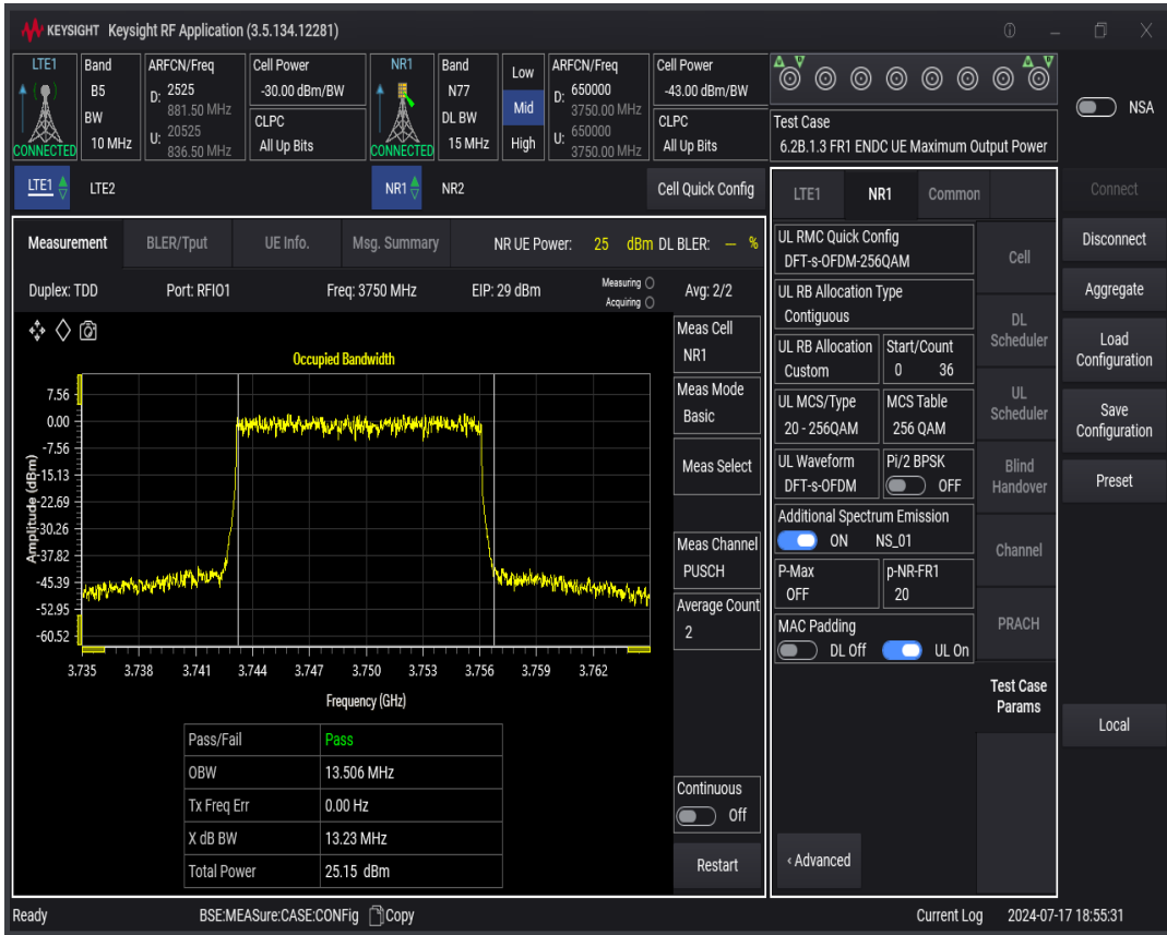
n77 SCS=30kHz DFT_QAM256 BW=20MHz Channel=650000 RB=50@0
