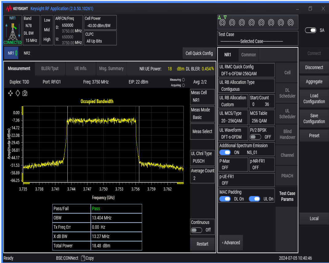
n78(3700-3800) SCS=30kHz DFT_QAM256 BW=20MHz Channel=65000 RB=50@0
