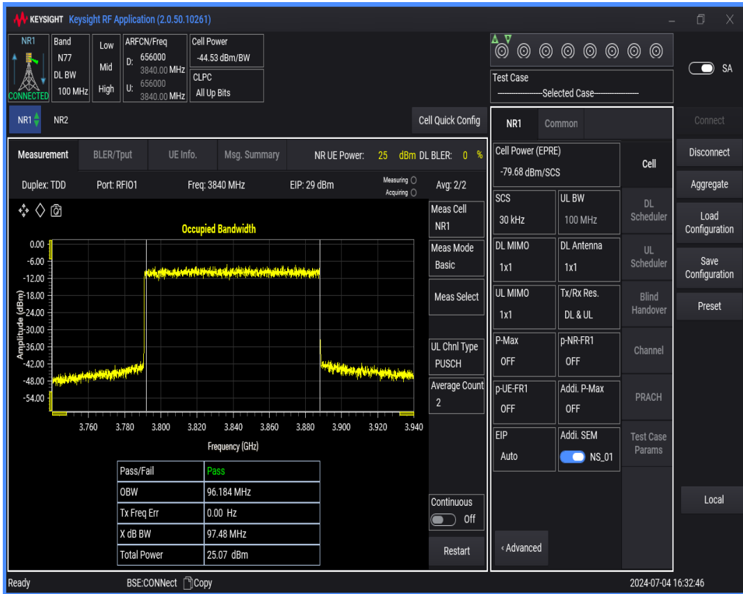
n77(3700-3980) SCS=30kHz DFT_QPSK BW=10MHz Channel=656000 RB=24 @0
