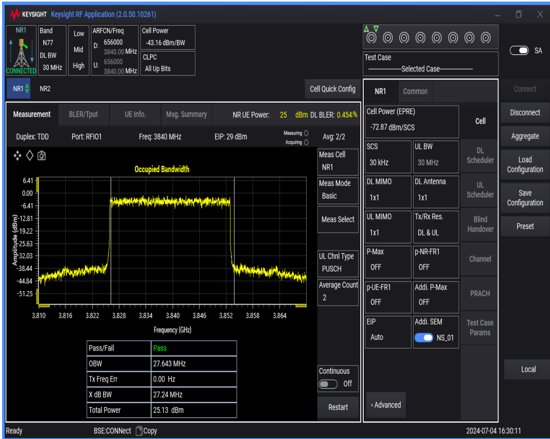
n77(3700-3980) SCS=30kHz DFT_QPSK BW=40MHz Channel=656000 RB=100 @0
