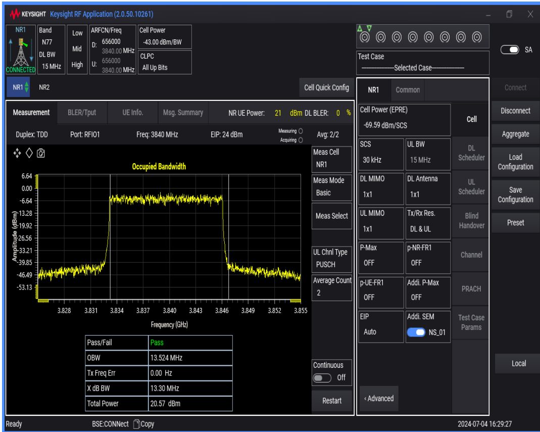
n77(3700-3980) SCS=30kHz DFT_QAM64 BW=20MHz Channel=656000 RB=50@0
