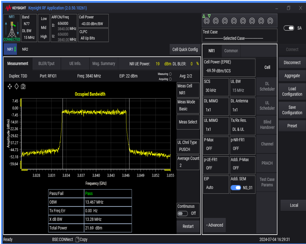
n77(3700-3980) SCS=30kHz DFT_QAM256 BW=20MHz Channel=656000 RB=50@0
