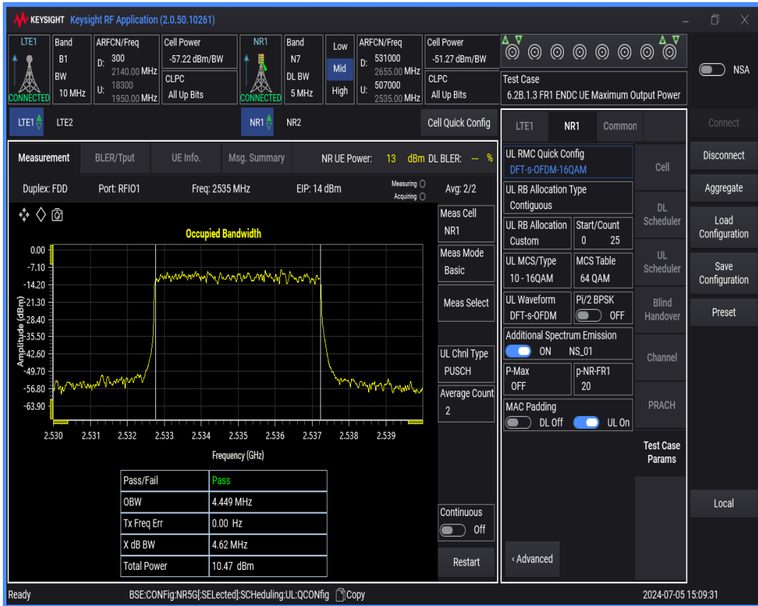
n7 SCS=15kHz DFT_QAM256 BW=10MHz Channel=507000 RB=50 @0
