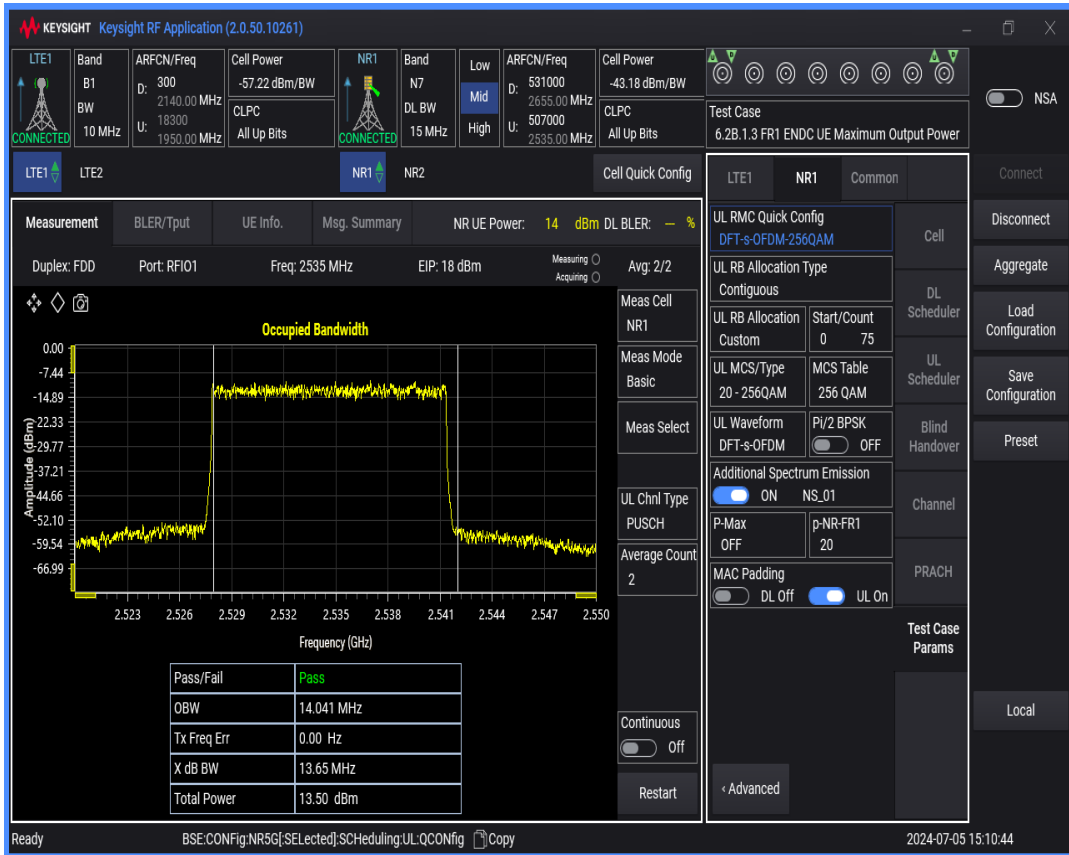
n7 SCS=15kHz DFT_QAM256 BW=20MHz Channel=507000 RB=100@0
