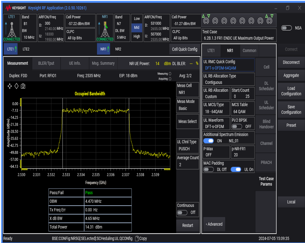
n7 SCS=15kHz DFT_QPSK BW=10MHz Channel=507000 RB=50 @0
