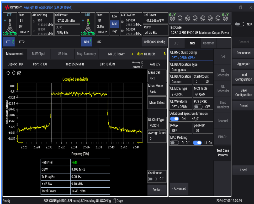
n7 SCS=15kHz DFT_QPSK BW=15MHz Channel=507000 RB=75 @0
