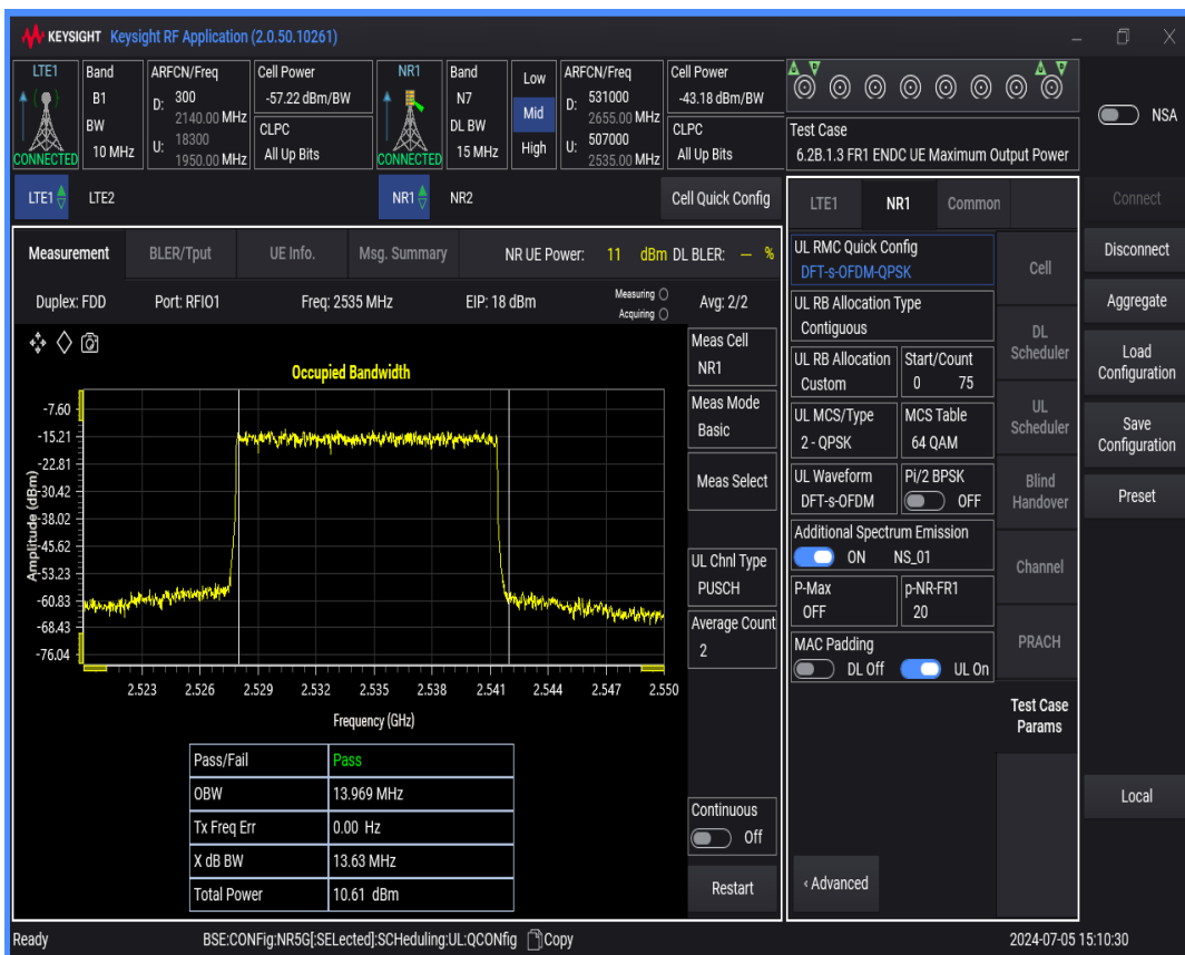
n7 SCS=15kHz DFT_QPSK BW=20MHz Channel=507000 RB=100 @0
