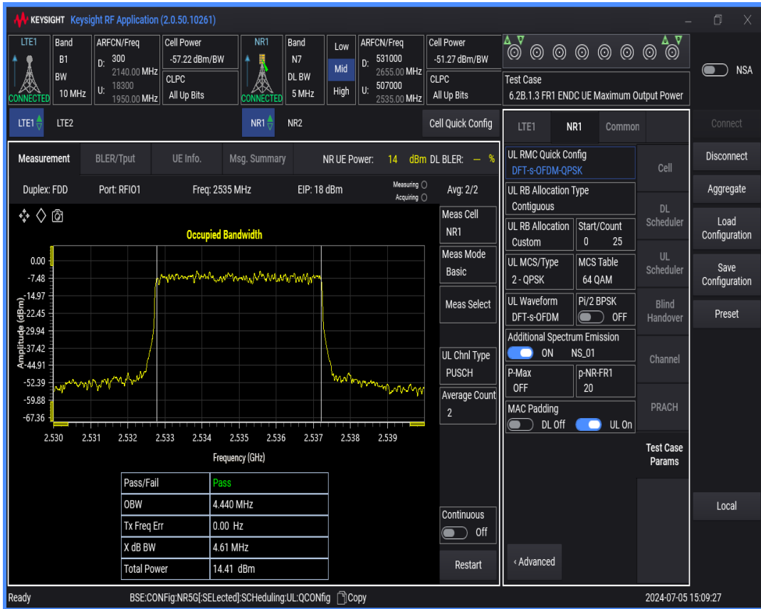
n7 SCS=15kHz DFT_QPSK BW=5MHz Channel=507000 RB=25@0
