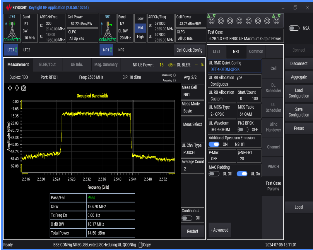
n7 SCS=15kHz DFT_QPSK BW=5MHz Channel=507000 RB=25@0
